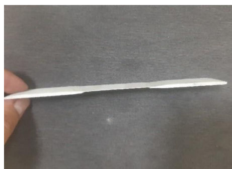
الشكل رقم (٢٠,٥): عينات شد الزجاج
