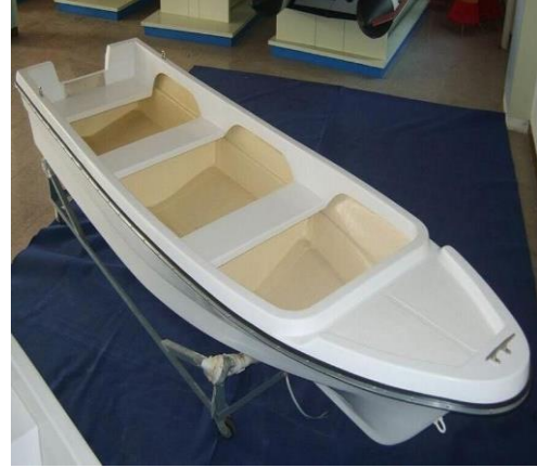
الشكل (١٣,٢): تطبيقات طريقة الرش بمسدس الرش
