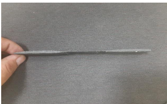
الشكل رقم (١٩,٥): عينات شد الكربون
