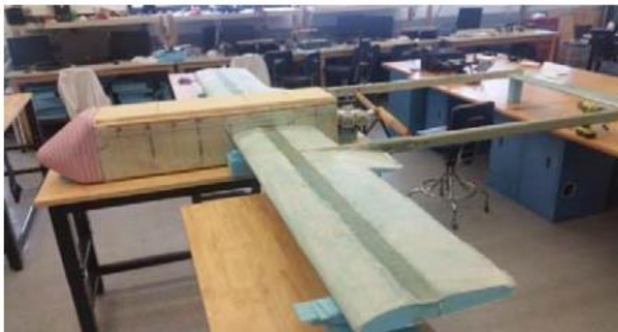
الشكل رقم (٢,٣): استخدام الستريوبور في الطائرة الاستطلاعية [15]
