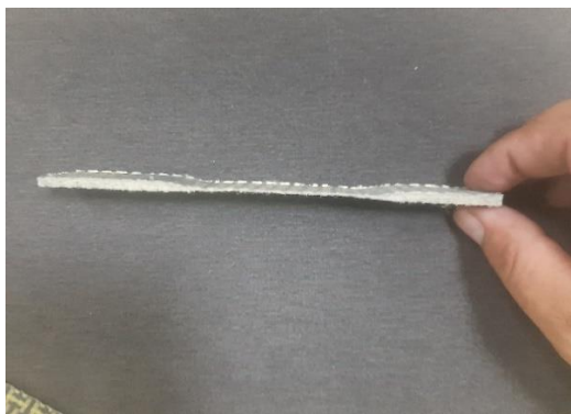
الشكل رقم (٢٢,٥) عينات شد الهجين
