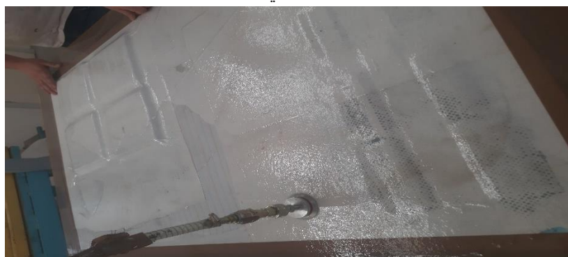
الشكل رقم (١٧,٥) تجهيز المحفظة البلاستيكية مع حلقات الشفط
