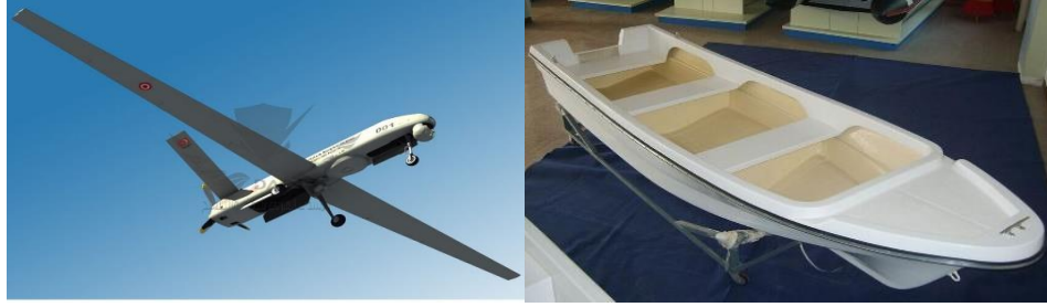
الشكل رقم (٣،٢): هيكل طائرة وقارب من مادة مركبة مقواة بألياف الزجاج.
