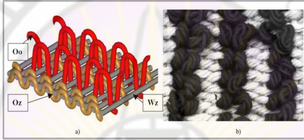
الشكل 13-19: الأقمشة الوبرية (لها حلقات) حيث O0: حلقات من السداء، oz سداء الأرضية wz : خيوط الأرضية، (b) أقمشة وبرية
