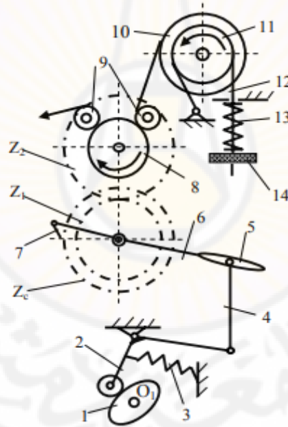
الشكل 3-4: الرسم التخطيطي لمنظم السداء الموجب، مع تدفق متقطع
