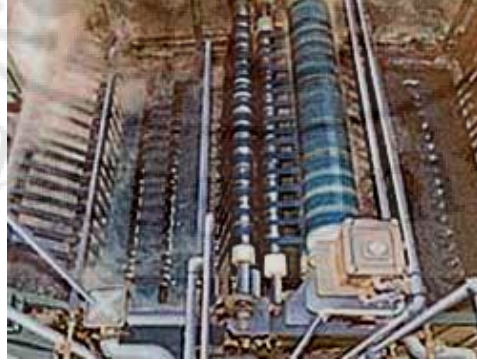
الشكل 12-2: صباغة الأنديجو بطريقة الحبل
