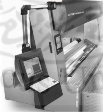
الشكل 11-4: نظام فحص الأقمشة Uster Fabricscan inspection system
