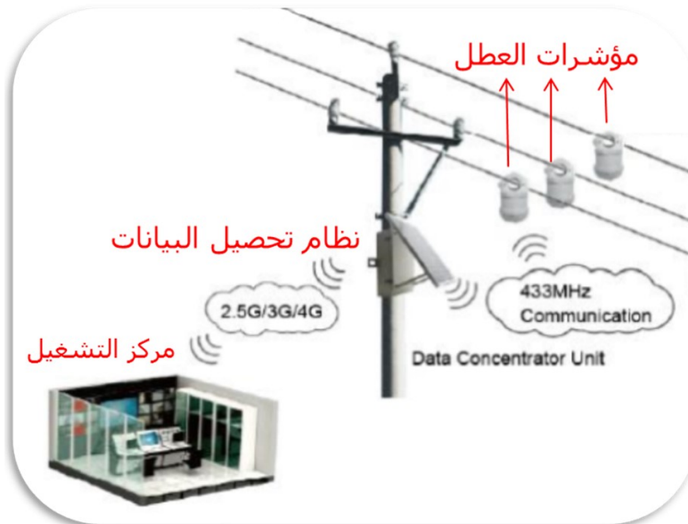
الشكل (3_4) اتصال مؤشرات الأعطال مع مراكز التشغيل عن طريق DCU
