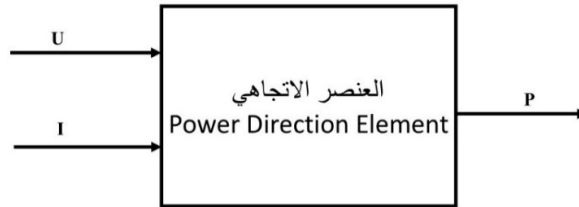
الشكل (2_7) مبدأ عمل العنصر الاتجاهي
