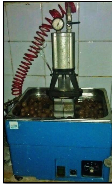
الشكل (2-22) : بوتقة الحقن مع مربطها وضاعطها تحت ضغط 6 بار في الجهاز الخاص بتصليب راتنج الحقن
