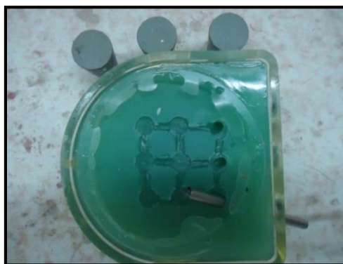
الشكل (2-28) : إدخال مجاري الصب (الأوتاد المعدنية المفرغة)
