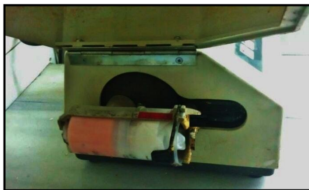
الشكل (2-21) : كبسولة راتنج الحقن في المكان المخصص لها في الهزاز الميكانيكي
