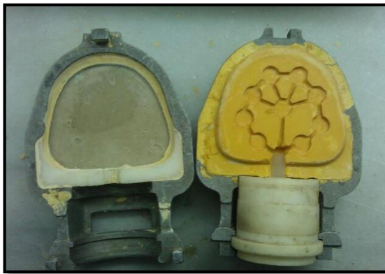
الشكل (2-20) : القالب الجبسي الناتج ضمن بوتقة الحقن بعد تمام تصلب الجبس في القاعدة والمعكس ، وتذويب الشمع ، وتنظيفها من جميع البقايا الشمعية
