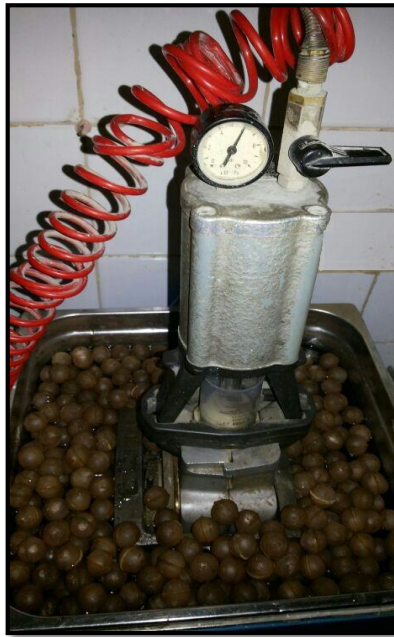
الشكل (2-23) : بوتقة الحقن مع مربطها وضاعطها في الجهاز الخاص بتصليب راتنج الحقن والكريات على سطح الماء لمنع وصول الحرارة إلى الكبسولة
