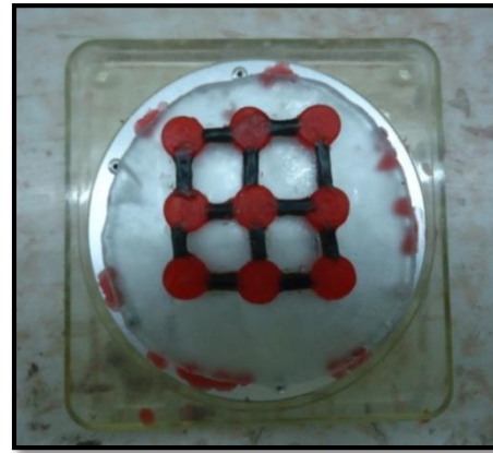
الشكل (2-24) : قاعدة بوتقة راتنج السكب الموضوع عليها اللوح الزجاجي والأقراص الشمعية مع الأوتاد الشمعية الواسلة بينها
