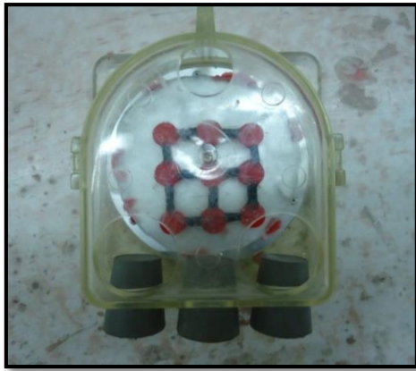
الشكل (2-25) : بوتقة راتنج السكب مع اللوح الزجاجي والأقراص الشمعية الموصولة بالأوتاد الشمعية
