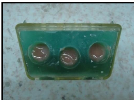
الشكل (2-29) : سكب الراتنج في المكان المخصص لمجرى الصب
