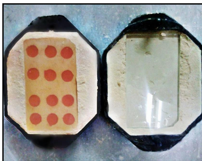
الشكل ( 2-18) : الأقراص الراتنجية ضمن البوتقة بعد إنتهاء عملية التصليب
