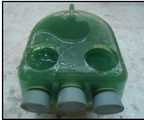
الشكل (2-26) : بوتقة راتنج السكب بعد ملئها بالآغار
