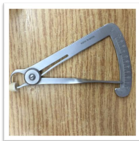
شكل (2-24): صورة توضح سماكة الخزف المغطي 1 ملم بعد الخبز
