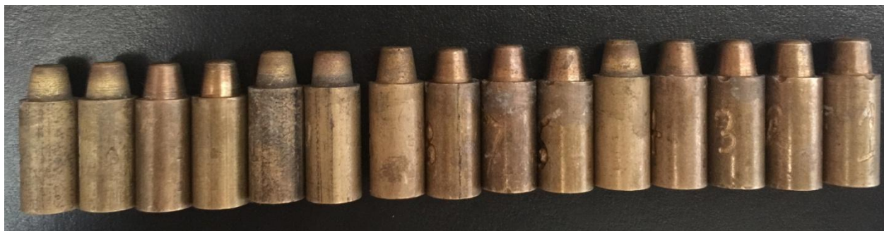
شكل (2-15): صورة الدعامات المعدنية بزاوية تحضير 20°
