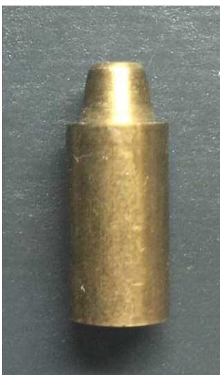
شكل (2-16): صورة توضح الدعامة المعدنية قبل اجراء الحفرة المانعة للدوران
