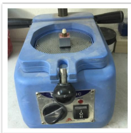
شكل (2-25): صورة توضح العينة ضمن جهاز vacumm من اجل صنع قالب ضبط السماكة
