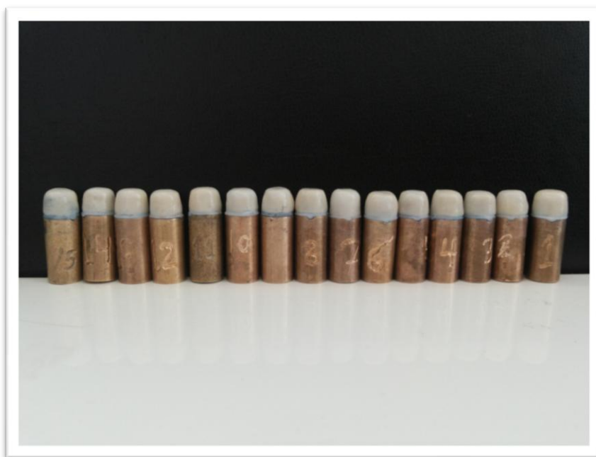
شكل (2-28): صورة للدعائم المعدنية بعد الصاق القبعات الزيركونية وخبز الخزف المغطي
