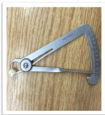
شكل (2-24): صورة توضح سماكة الخزف المغطي 1 ملم بعد الخبز
