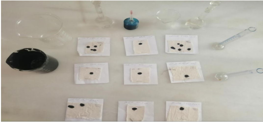
الشكل (38-4): صور القطع النسيجية بعد تجربة القطرات
