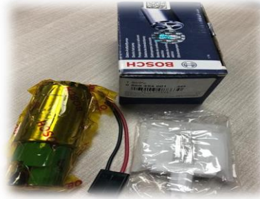
الشكل (8-20) المضخة المستخدمة لضخ خليط الميثانول مع الماء
