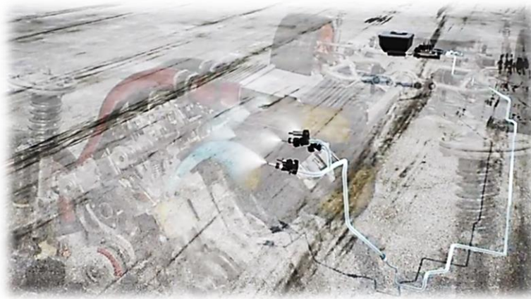
الشكل (41-6) مخطط نظام حقن الماء
