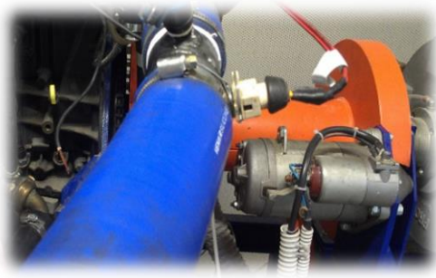
شكل (9-4) تركيب حساس درجة حرارة هواء الشحن
