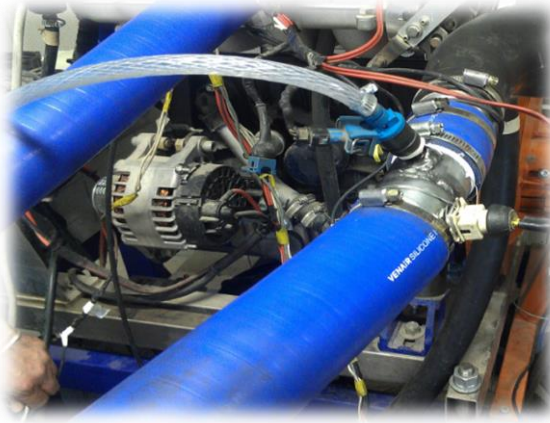
الشكل (8-22) حاقن خليط الميثانول مع الماء
