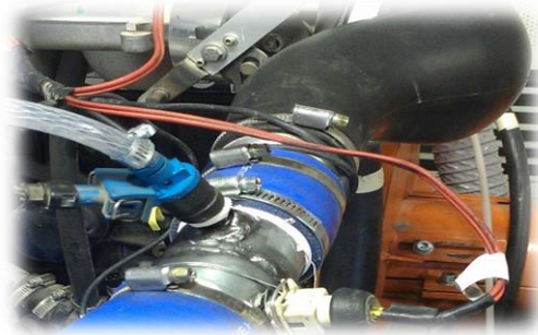
شكل (9-5) تركيب حاقن خليط الميثانول مع الماء
