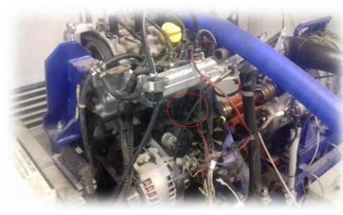
الشكل (8-18) حساس الصفع ضمن الدائرة الحمراء وتوضعه على جسم المحرك
