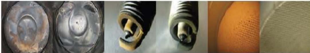
الشكل (1-8) تأثير جودة الوقود على غرفة الاحتراق والمحفز وشمعات الإشعال الشق الأيسر من الصور الوقود المستخدم في الصين أما في الشق الأيمن الوقود المستخدم في دول الاتحاد الأوروبي
