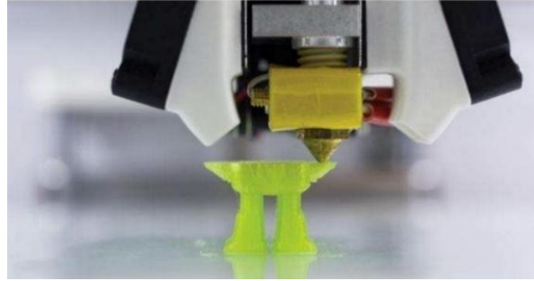
الشكل (20) بثق مادة PLA من رأس الطباعة
