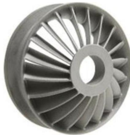
الشكل (15) نماذج مطبوعة بتقنية DMLS
