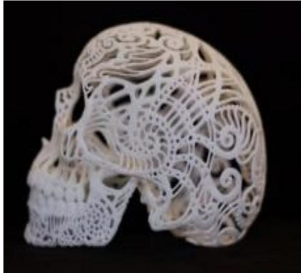
الشكل (13) نماذج مطبوعة بتقنية SLS
