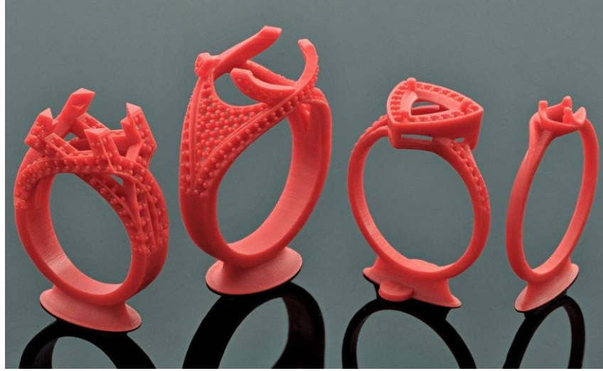
الشكل (9) نماذج مطبوعة بتقنية LCD
