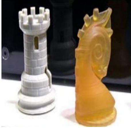
الشكل (7) نماذج مطبوعة بتقنية SLA
