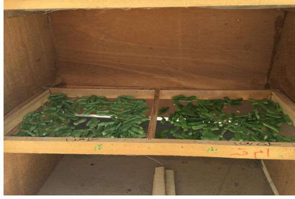
الشكل (7): عينات الفاصولياء المجففة باستخدام المجفف الشمسي
