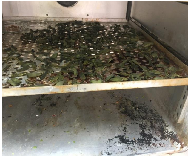
الشكل (8): عينات الفاصولياء المجففة باستخدام الهواء الساخن
