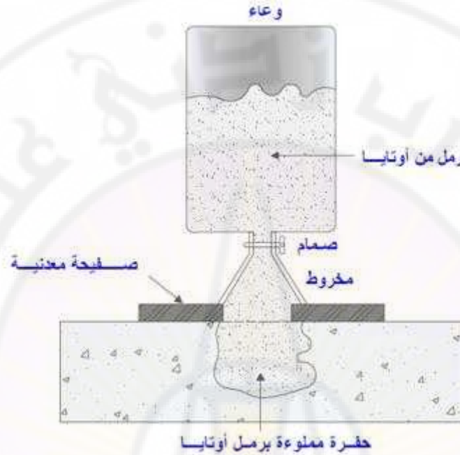
الشكل (22.6) : جهاز مخروط الرمل عند ملئ الحفرة بالرمل
