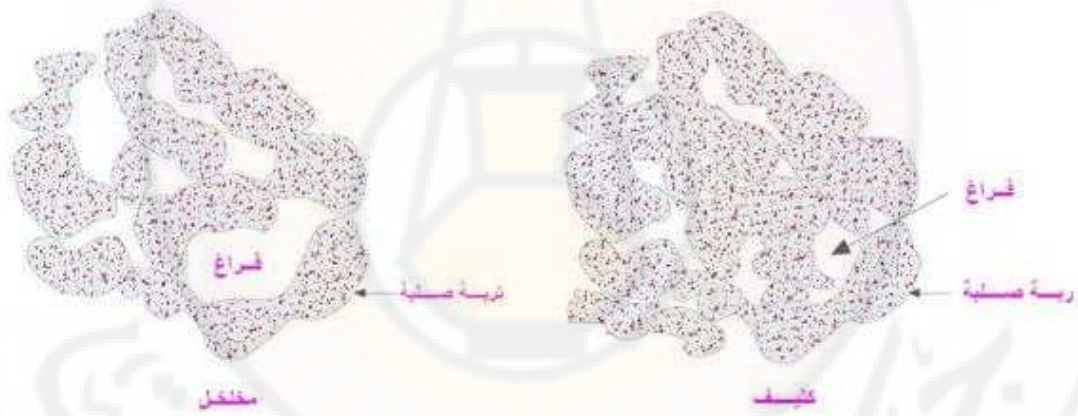
الشكل (18.4): شكل هيكل التربة: (a) مخلخل، (b) متراص
