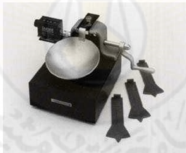
الشكل (3.4): تجربة حد السيولة
