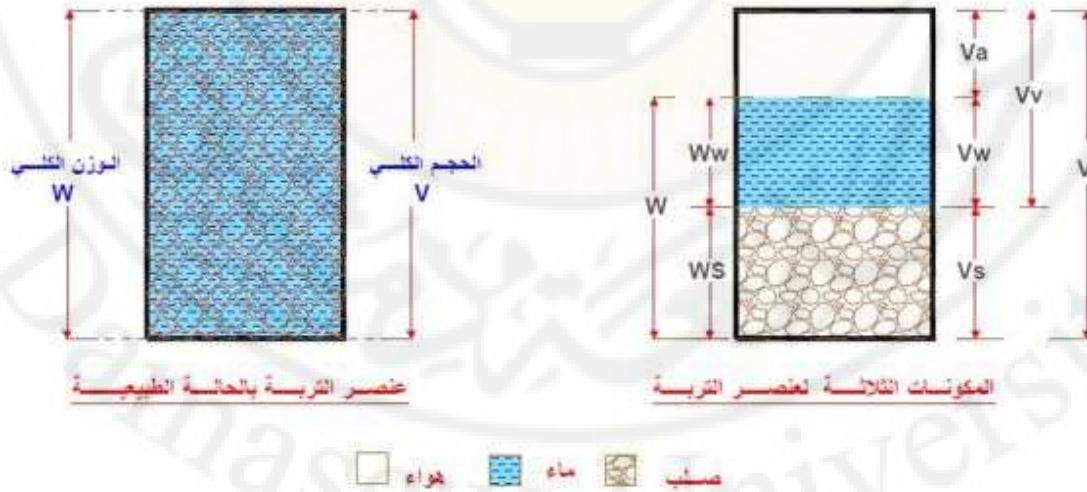
الشكل (1.3): (a) عنصر تربة بالحالة الطبيعية، (b) الأطوار الثلاثة لعنصر التربة
