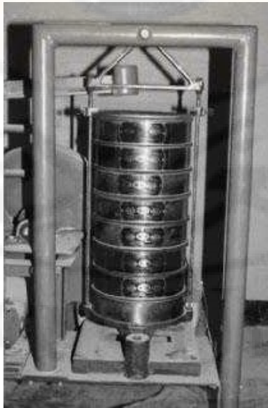
الشكل (21.2) : مجموعة من المهزات في هزاز مستخدم للقيام بالتجربة في المخبر
