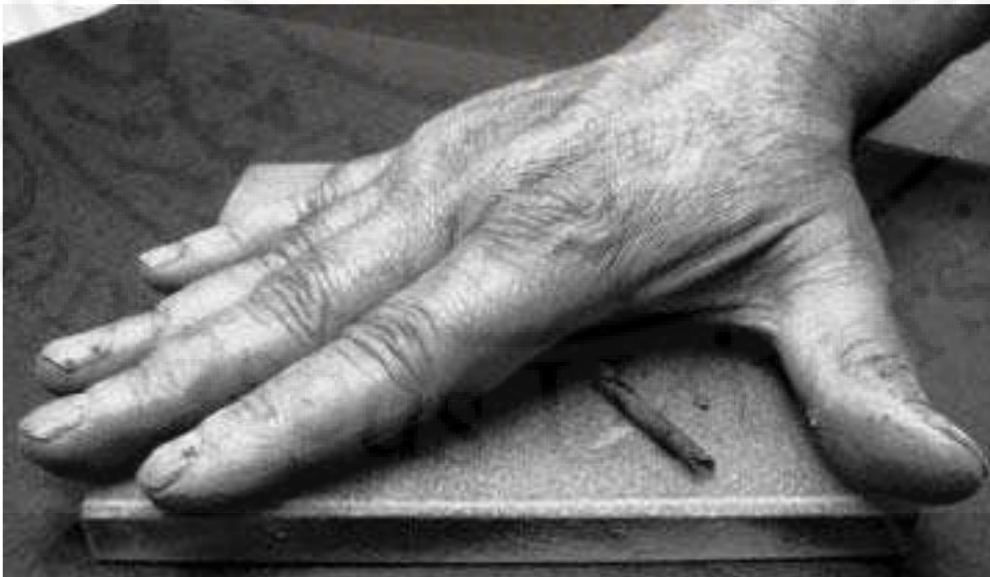
الشكل (7.4): الفتائل لقياس حد اللدونة
