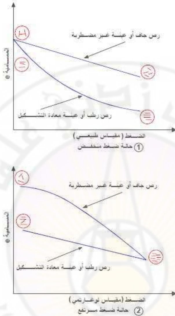
الشكل 12-6 : تأثير الرصد على الانضغاطية باتجاه واحد في الترب الغضارية Redrawn after Lambe 1958,a .With permission from ASCE
