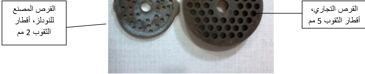
الشكل 13 القرص المصنع محلياً بما يلائم إنتاج نودلز ذات خيوط رفيعة
