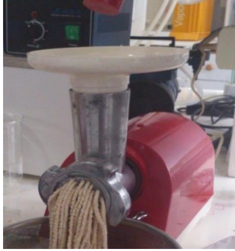
الشكل 12 جهاز البثق اللولبي
