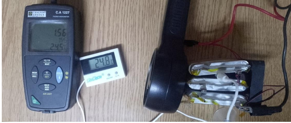
الشكل (٤-١٥) قياس سرعة هواء التبريد عندما تكون المدخرة ممتلئة
