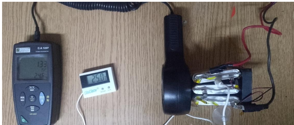
الشكل (١٤-٤) قياس سرعة هواء التبريد عندما تكون المدخرة فارغة
