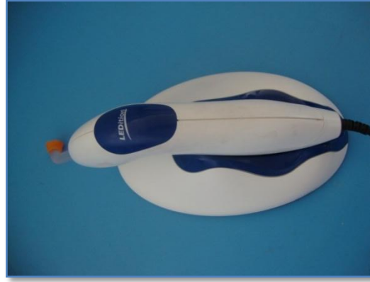
شكل رقم ( 8_2 ): جهاز التصليب الضوئي LEDITION
