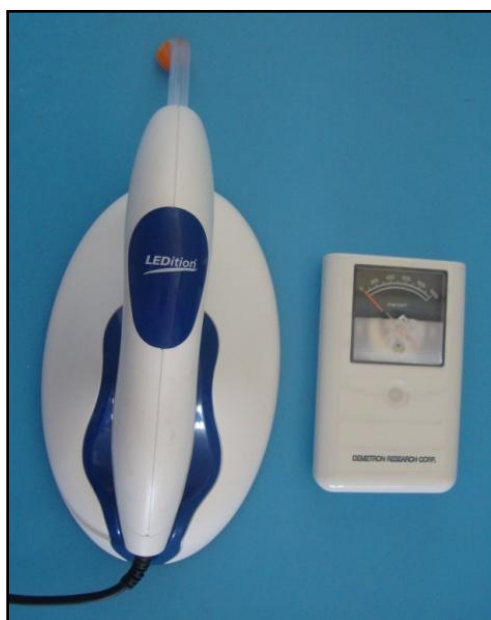
شكل رقم ( 2_10 ): مقياس الشدة مع جهاز التصلب الضوئي المستخدم
