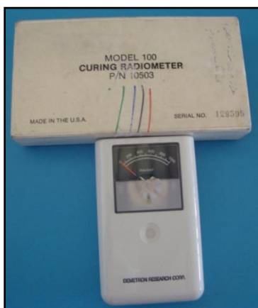
شكل رقم ( 2_9 ): مقياس الشدة المستخدم في البحث
