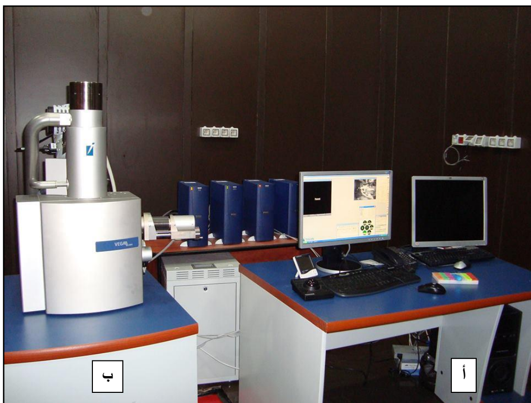
شكل رقم ( 2_7 ) : المجهر الإلكتروني الماسح. أ- الحاسوب المزود ببرنامج خاص لقراءة الصور. ب- الحجرة
