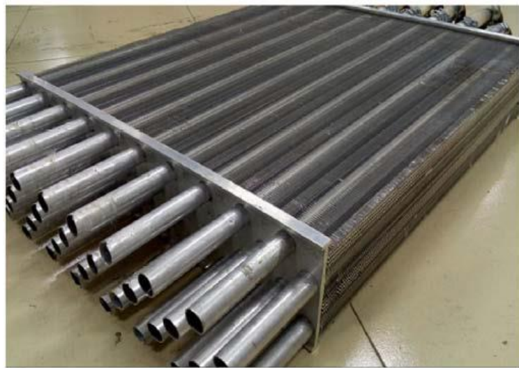
الشكل (3) المبادل الحراري من نوع flat fin ونوع slotted fin
