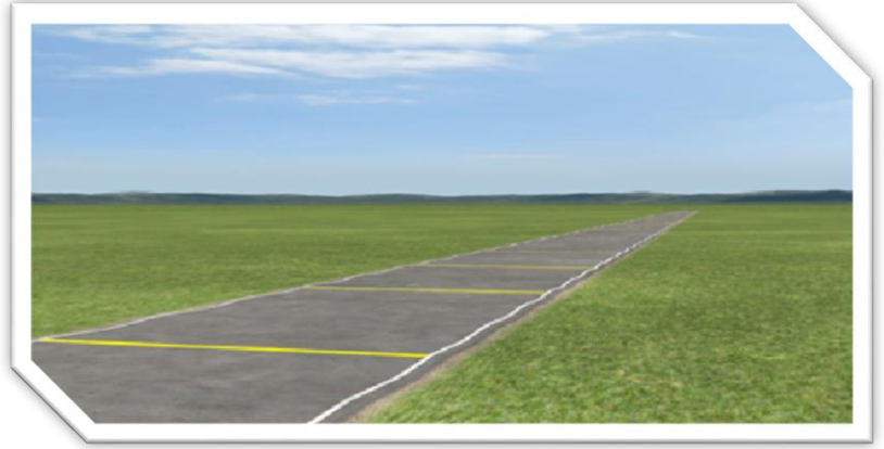
الشكل (٤٦): طريق متموج طولياً بسعات مختلفة
