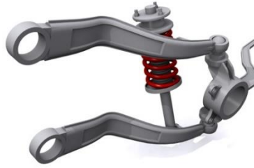
الشكل (٣٢): نظام التعليق الخلفي المستقل من نوع (Tri-Link (3-Link)
