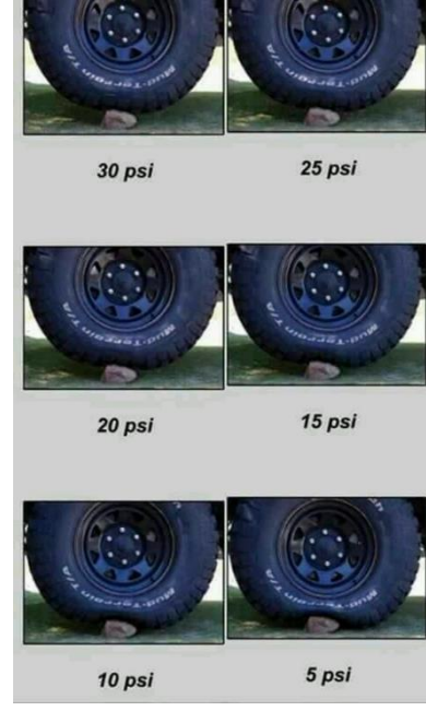
الشكل (٣٨): أبعاد العجلة وتأثير ضغط الإطارات عند خشونة الطريق
