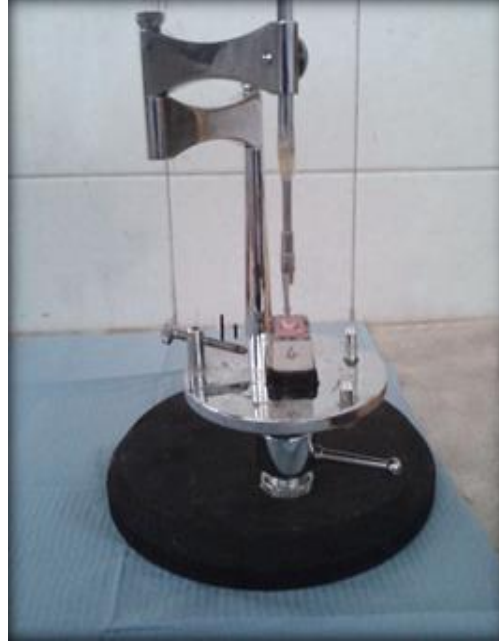
الشكل (2-49): وضع الجذر ضمن القاعدة المملوءة بالأكريل ذاتي التصلب لصنع القواعد السفلية.
