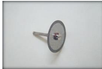
الشكل (2-2): قرص الفصل الماسي مركباً على حامله الخاص.
