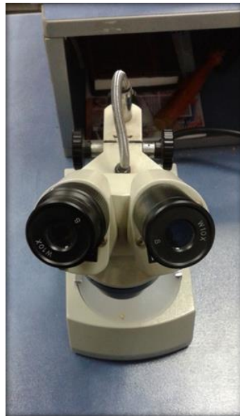
الشَّكْل (11-2): المنظار المُجَسِّم Stereoscope.
