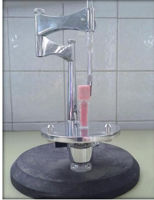
الشكل (2-50): وضع الوند ضمن العلبة البلاستيكية المملوءة بالأكريل ذاتي التصلب لصنع القواعد العلوية.
