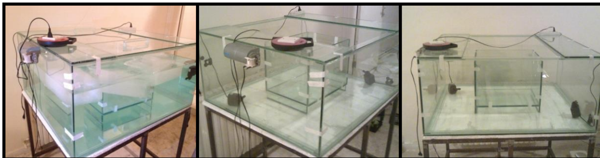
الشكل (18) التصميم العام لمعدات جهاز التبريد الأولي بالماء المثلج مع ظهور مضخة الماء وتوربين الهواء
