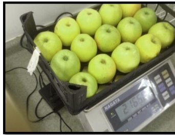
الشكل (25) ميزان كهربائي حساس لقياس الفقد الطبيعي في الوزن
