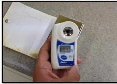
الشكل (28) جهاز رفاكتوميتر لقياس نسبة المواد الصلبة الذائبة
