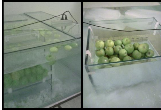
الشكل (21) مبدأ عمل جهاز التبريد الأولي بالتوصيل المائي
