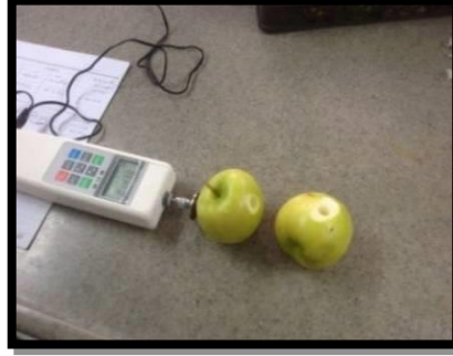
الشكل (27) جهاز بينيتروميتر لقياس صلابة الثمار
