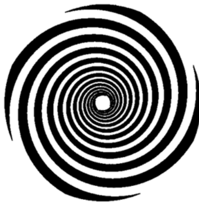
الشكل (3-5) هوائي حلزوني متعلق بالزاوية بأربع أذرع ( EF = 2.32 )
