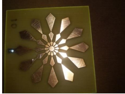
الشكل (52-5) هوائي تجزئي شبه معين عملي
