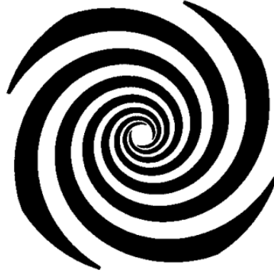
الشكل (4-5) هوائي حلزوني متعلق بالزاوية بأربع أذرع ( EF = 4.64 )
