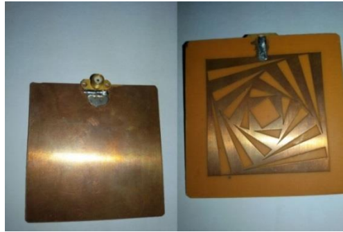
الشكل (45-5) الهوائي المربع التجزئي المطور عملياً
