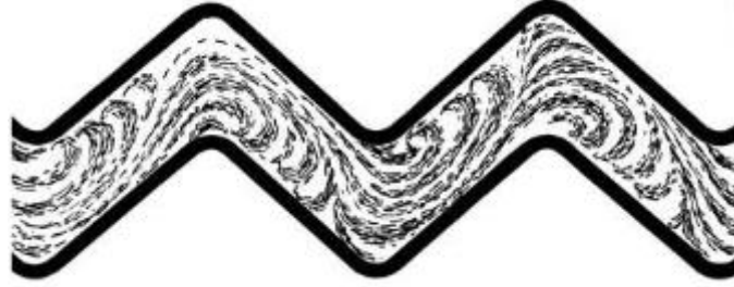
شكل (36) التدفق المضطرب في المبادل الصفائحي [15]
