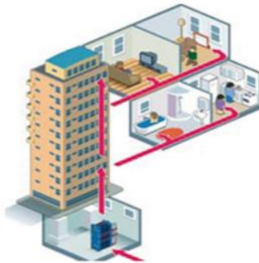
شكل (34) تطبيق مبادل في نظام التدفئة المركزية
