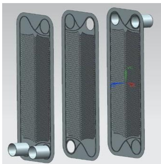
شكل (55) الشكل الهندسي لمبادل بثلاث صفائح
