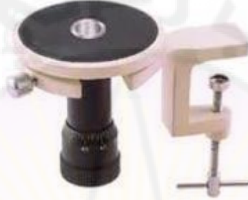
شكل 23: المقطاع اليدوي، ويستخدم عادة في تقطيع النسيج النباتية .
