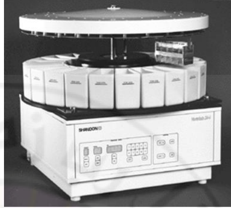
شكل 38: جهاز التلوين الآلي و يبدو فيه حامل الصفائح يدور أو ينتقل على أحواض التلوين حسب البرنامج المؤتمت.
