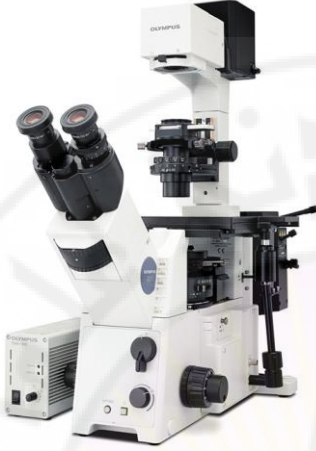
شكل 14: المجهر الضوئي المقلوب.
