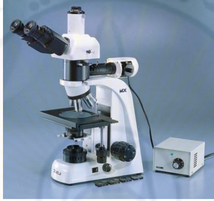
شكل 7: المجهر مظلم الحقل
