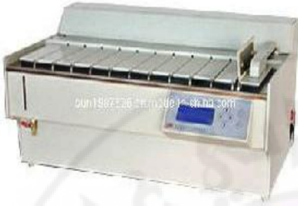
شكل 38: جهاز التلوين الآلي و يبدو فيه حامل الصفائح يدور أو ينتقل على أحواض التلوين حسب البرنامج المؤتمت.
