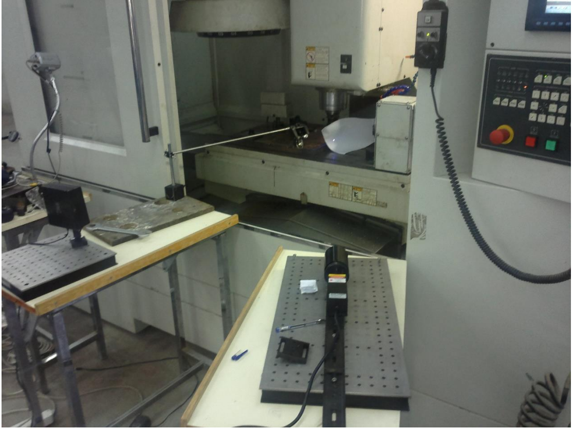
الشكل (5-12) الطريقة الضوئية لكشف حالة الاهتزازات المحرصة ذاتياً
