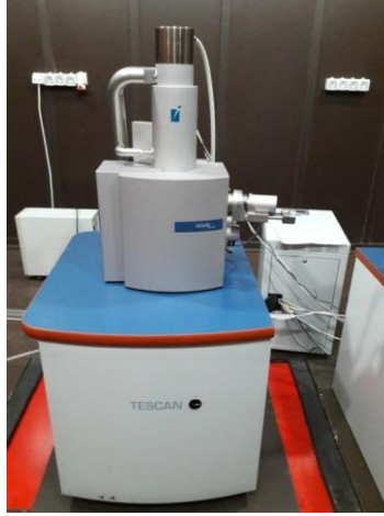
الصورة (18) المجهر الالكتروني الماسح
