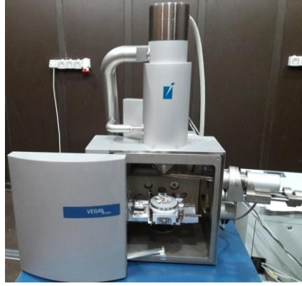
الصورة (31) الحجرة الداخلية ل SEM
