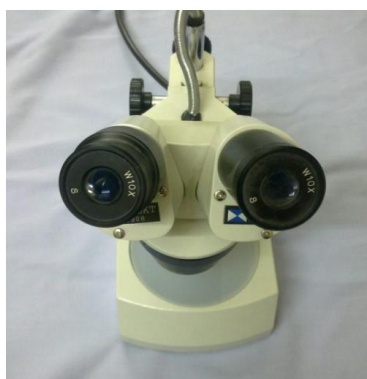
الصورة (17) تبين المجهر المجسم المستخدم في البحث
