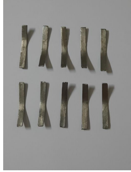
الشكل (21) قطع التيتانيوم منحنية دون حدوث كسر.
