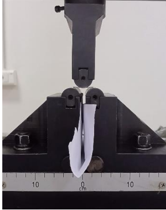
الشكل (20) جهاز الاختبارات الميكانيكية العامة، حيث وُضعت قطعة الاختبار على العمودين الداعمين.
