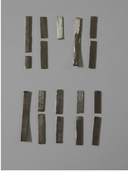
الشكل (22) قطع الكوبالت كروم مكسورة باستثناء قطعتين.
