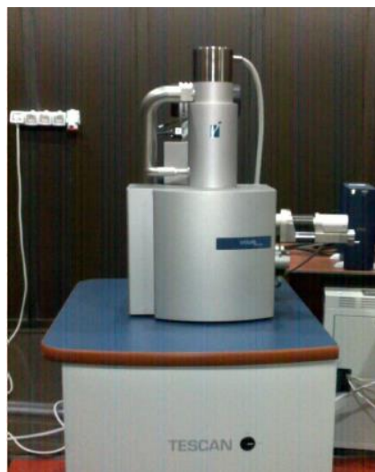
الشكل (7-4): المجهر الإلكتروني الماسح (SEM) مزود بمطيافية (EDX).
