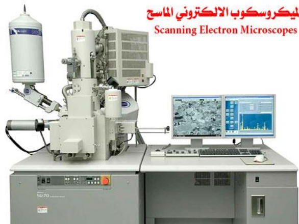
الشكل (3-10): المجهر الإلكتروني الماسح (SEM).
