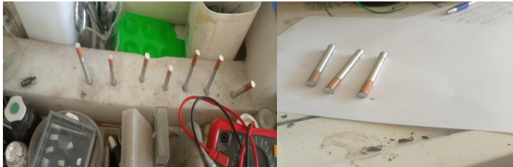
الشكل (4-12): عينات اسطوانية من أجل اختبار التآكل الكهروكيميائي بعد طلاء الحواف.
