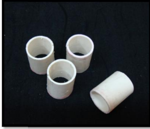
شكل 14.2: قوالب بلاستيكية لصناعة القواعد الإكريلية
