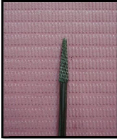
شكل 18.2: رأس خاص بالـ Milling Machine معدّ لضبط درجة ميلان الجدران بمقدار 10 درجات
