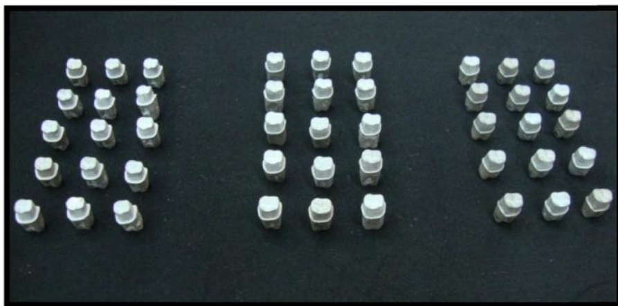
شكل 25.2: الدعامات المعدنية لكل نموذج من نماذج خطوط الإنهاء
