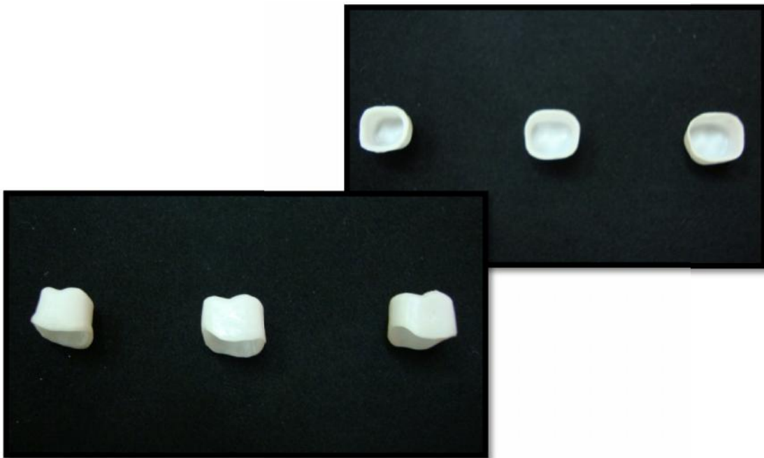
شكل 32.2: النماذج الثلاثة للقبعات بعد تصنيعها وتلييدها
