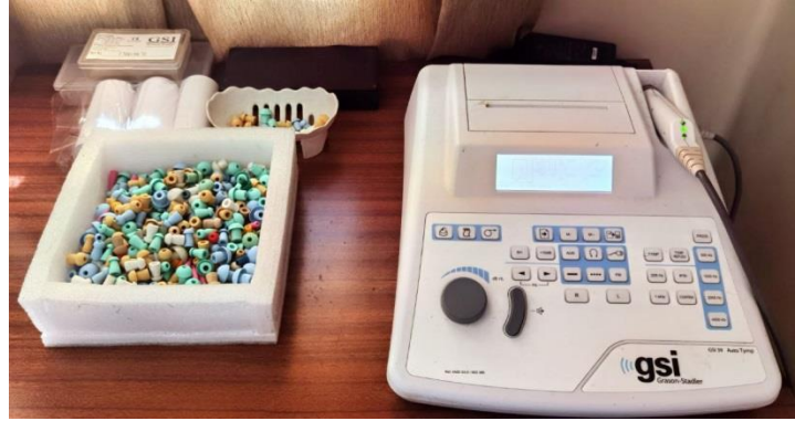
صورة -1: جهاز المعاوقة السمعية المستخدم في الدراسة - GSI 39 Auto Tym
