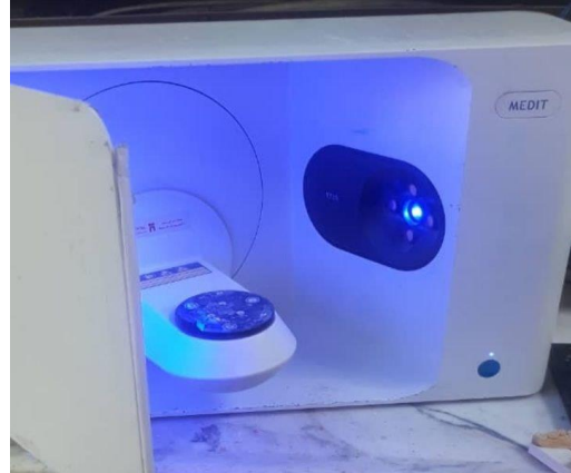
شكل رقم 2-21 يوضح الجهاز الماسح الضوئي من شركة Medit إصدار T710
