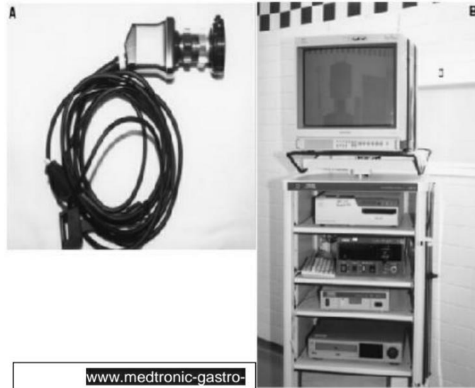
الشكل رقم 17: معدات الفيديو: (A) الكاميرا، (B) البرج (الشاشة، الطابعة، المنبع الضوئي، قناة الفيديو للكاميرا ومسجل الفيديو).
