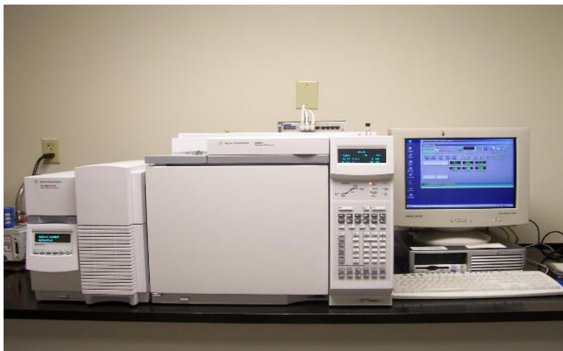
الشكل رقم (2): جهاز الكروماتوغرافي Gas chromatography Mass spectroscopy.
