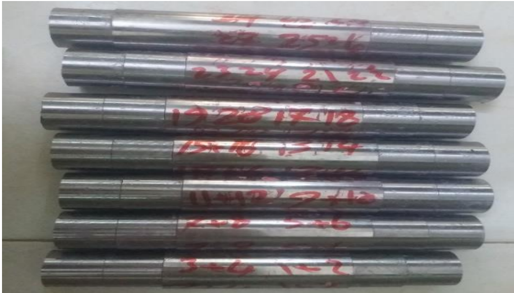
الشكل (6.5): العينات بعد إجراء عملية الخراطة
