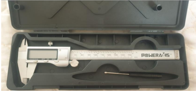
الشكل (7): يبين أداة القياس الرقمية المستخدمة في البحث
