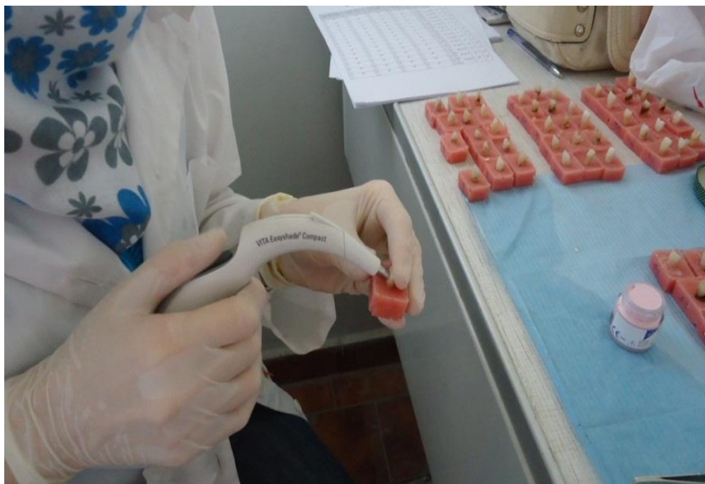
الشكل (29) قياس لون أسنان العينة باستخدام جهاز EasyShade
