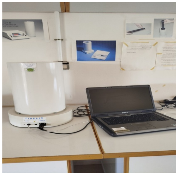
الشكل (4-1) جهاز قياس النشاط الإشعاعي المرجعي (NPL)
