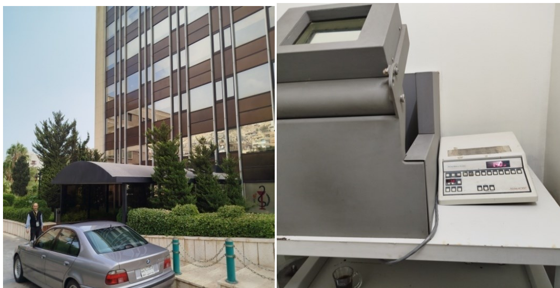
الشكل (4-5) جهاز قياس النشاط الإشعاعية (ATOMLAB100)
