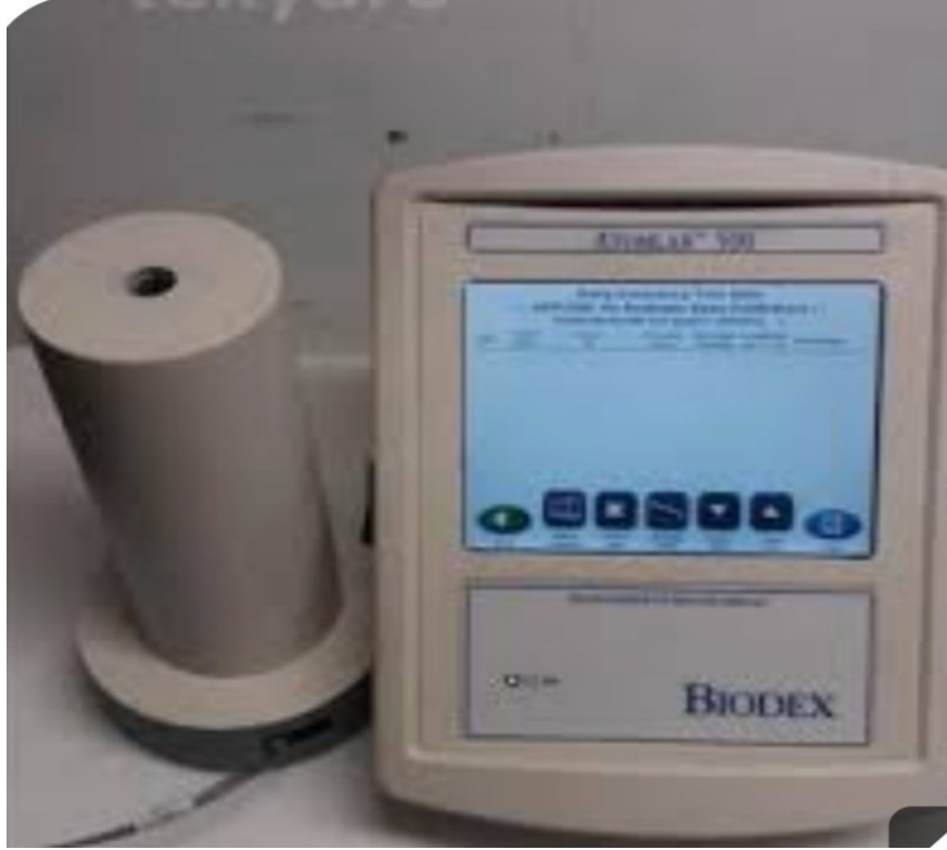
الشكل (4-4) جهاز قياس النشاط الإشعاعي (ATOMLAB500)
