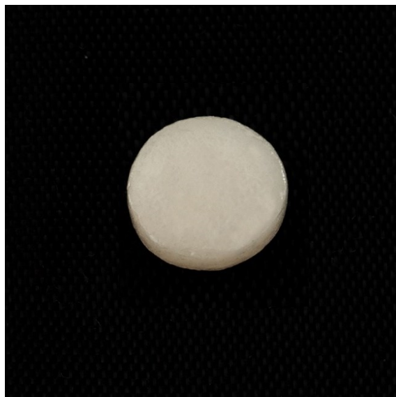
الشكل 30 إحدى عينات الخزف ثنائي سيليكات الليثيوم بعد التبييض باستخدام بيروكسيد الهيدروجين
