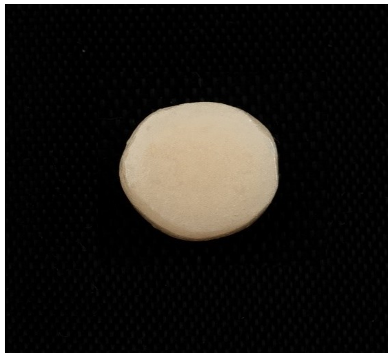
الشكل 28 إحدى عينات الخزف الفلدسباري بعد التبييض باستخدام بربورات الصوديوم
