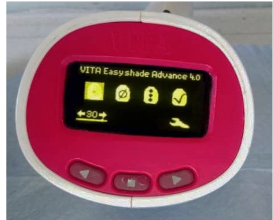
الشكل 34 يوضح خيارات القياس المتوفرة في الجهاز
