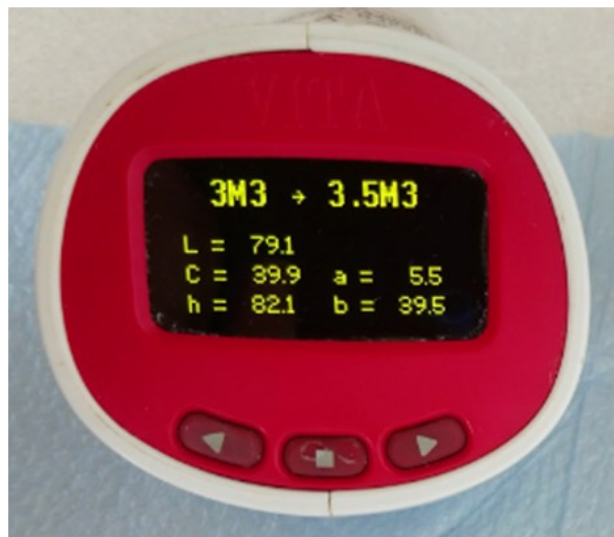
الشكل 39 يوضح شاشة الجهاز بعد قياس اللون بعد عملية التبييض بمادة برورات الصوديوم، الصورة الى اليمين لعينة من الخزف الفلدسباري والى اليسار عينة من الخزف ثنائي سيليكات الليثيوم.
