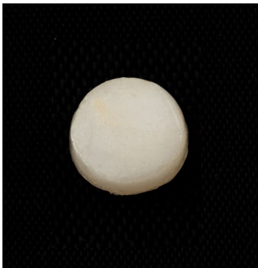
الشكل 27 إحدى عينات الخزف ثنائي سيليكات الليثيوم قبل التلوين
