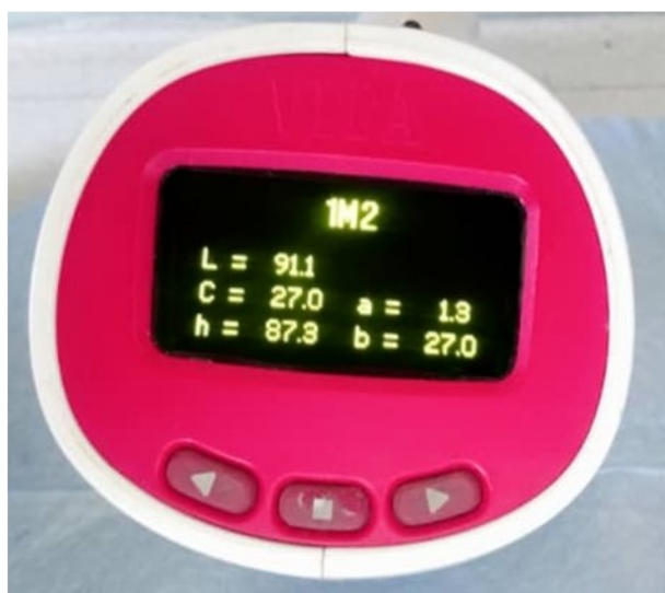
الشكل 37 يوضح شاشة الجهاز بعد قياس اللون قبل التلوين، الصورة الى اليمين لعينة من الخزف الفلدسباري والى اليسار عينة من الخزف ثنائي سيليكات الليثيوم
