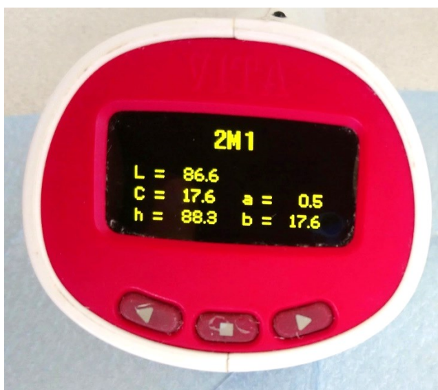
الشكل 40 يوضح شاشة الجهاز بعد قياس اللون بعد عملية التبييض بمادة بيروكسيد الهيدروجين، الصورة الى اليمين لعينة من الخزف الفلدسباري والى اليسار عينة من الخزف ثنائي سيليكات الليثيوم.
