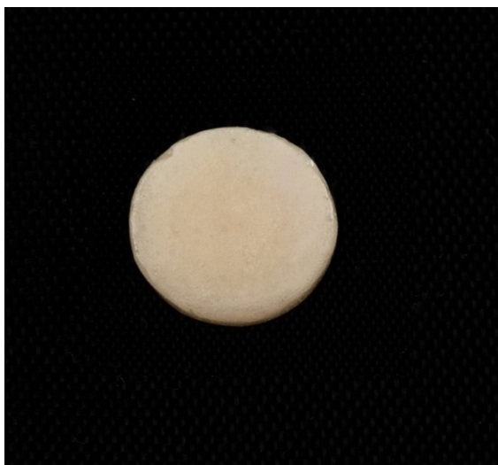
الشكل 25 إحدى عينات الخزف الفلدسباري قبل التلوين
