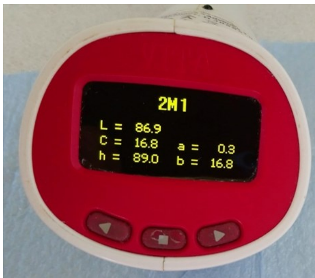
الشكل 39 يوضح شاشة الجهاز بعد قياس اللون بعد عملية التبييض بمادة برورات الصوديوم، الصورة الى اليمين لعينة من الخزف الفلدسباري والى اليسار عينة من الخزف ثنائي سيليكات الليثيوم.
