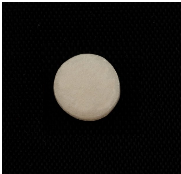
الشكل 31 إحدى عينات الخزف ثنائي سيليكات الليثيوم بعد التبييض باستخدام بربورات الصوديوم
