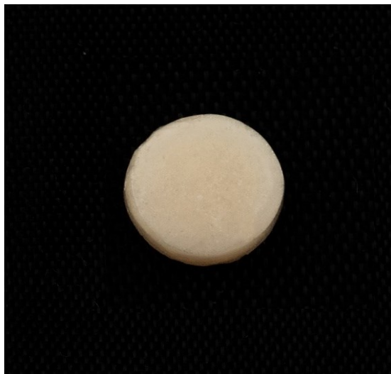
الشكل 29 إحدى عينات الخزف الفلدسباري بعد التبييض باستخدام بيروكسيد الهيدروجين
