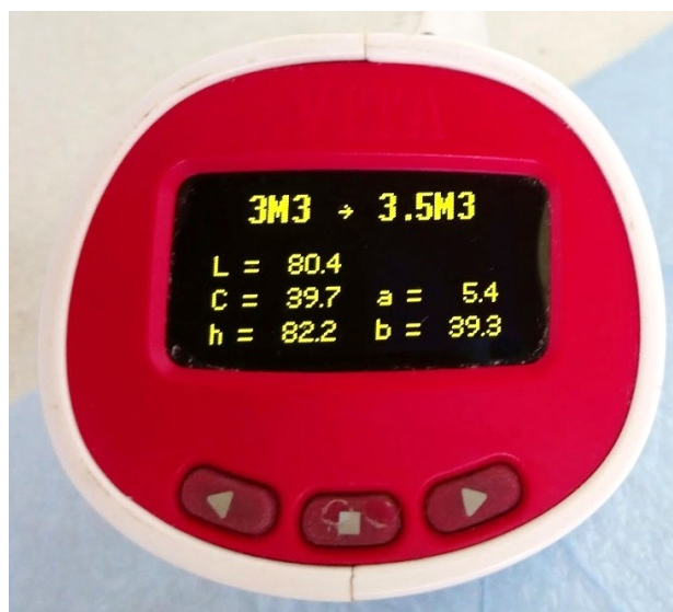
الشكل 40 يوضح شاشة الجهاز بعد قياس اللون بعد عملية التبييض بمادة بيروكسيد الهيدروجين، الصورة الى اليمين لعينة من الخزف الفلدسباري والى اليسار عينة من الخزف ثنائي سيليكات الليثيوم.
