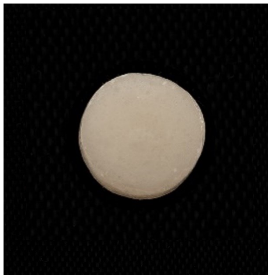
الشكل 24 إحدى عينات الخزف ثنائي سيليكات الليثيوم بعد التلوين
