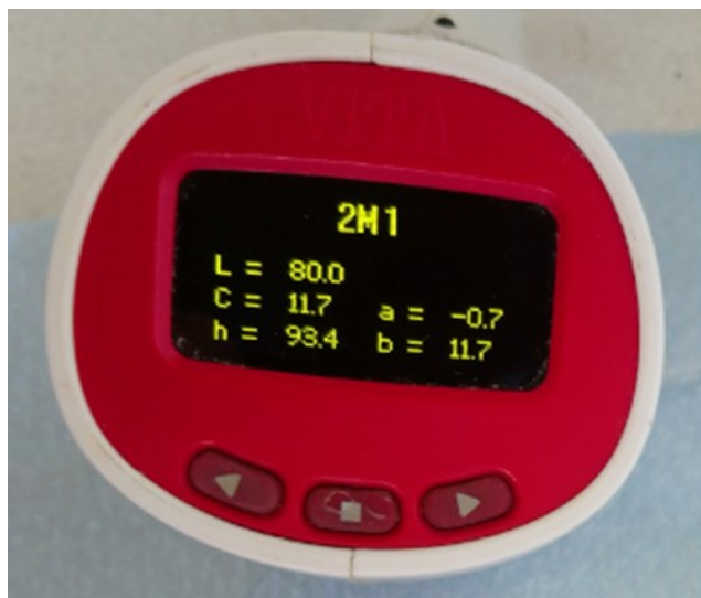
الشكل 37 يوضح شاشة الجهاز بعد قياس اللون قبل التلوين، الصورة الى اليمين لعينة من الخزف الفلدسباري والى اليسار عينة من الخزف ثنائي سيليكات الليثيوم
