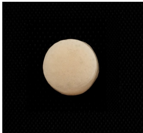
الشكل 26 إحدى عينات الخزف الفلدسباري بعد التلوين
