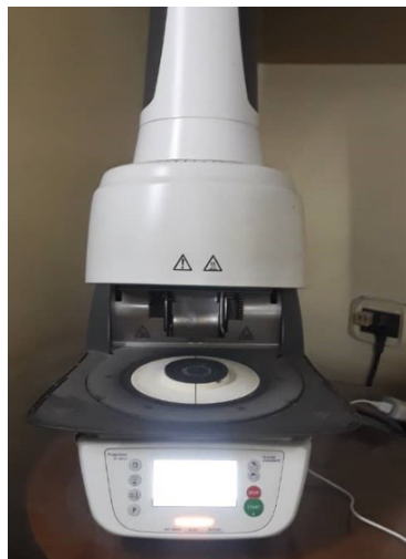
الشكل 9 جهاز حقن الخزف ثنائي سيليكات الليثيوم
