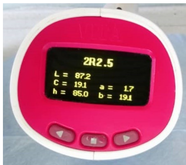
الشكل 38 يوضح شاشة الجهاز بعد قياس اللون بعد عملية التلوين، الصورة إلى اليمين لعينة من الخزف الفلدسباري وإلى اليسار عينة من الخزف ثنائي سيليكات الليثيوم.
