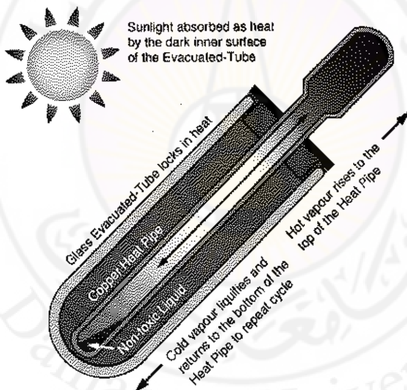
شكل 3-21: تمثيل تخطيطي لمبدأ عمل اللاقط الأسطواني المفرغ ذي الأنبوب الحراري [8]
