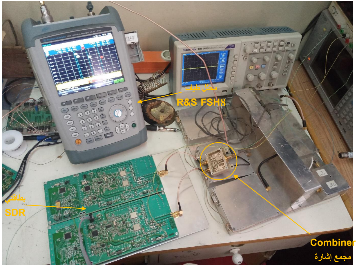
الشكل (7-1): مرحلة تهيئة واختبار بطاقتي SDR [الباحث]
