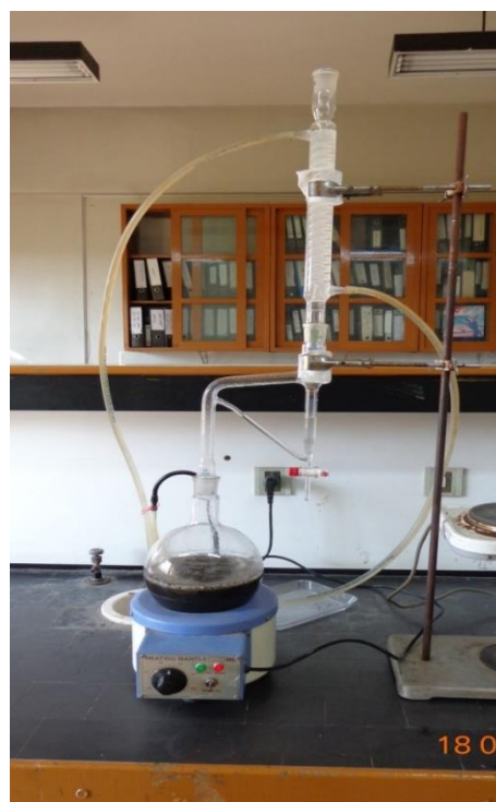
الشكل رقم 2 : جهاز التقطير بالبخار
