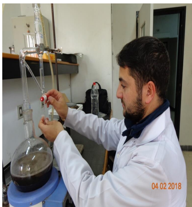
الشكل رقم 2 : جهاز التقطير بالبخار
