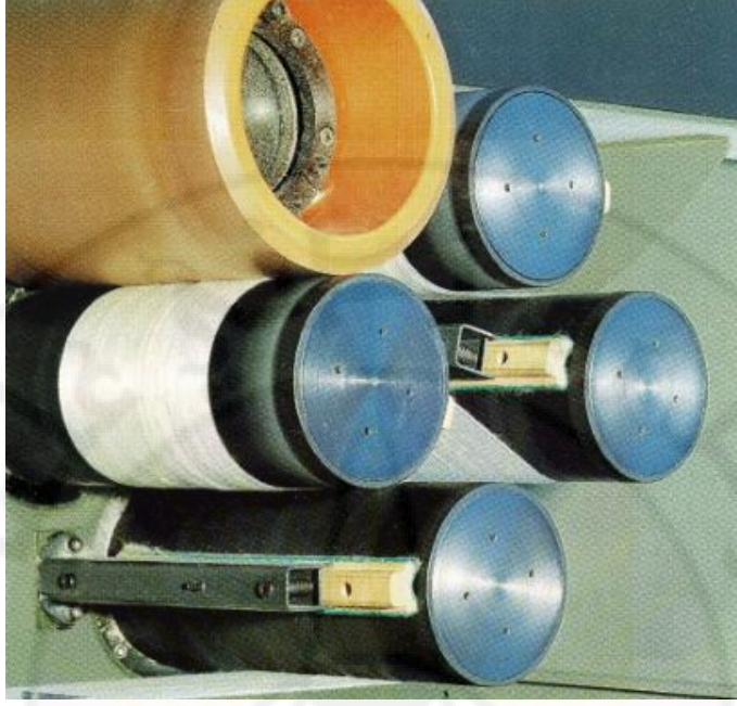
الشكل 8-1: جهاز شد الألياف بواسطة عدة أزواج من الأسطوانات خلفية وأمامية
