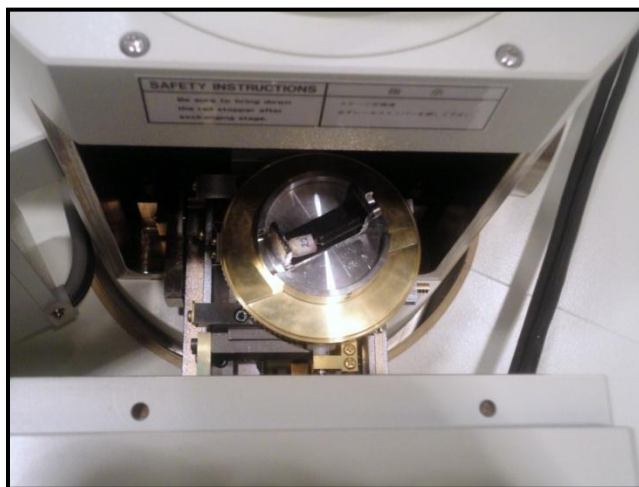
شكل (29.2): وضع العينة المراد قياسها ضمن المجهر الإلكتروني الماسح.
