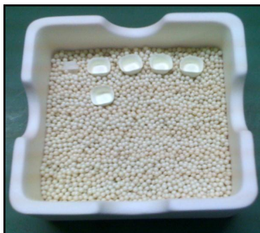
شكل (21.2): القوالب الزيركونية بعد التلييد.
