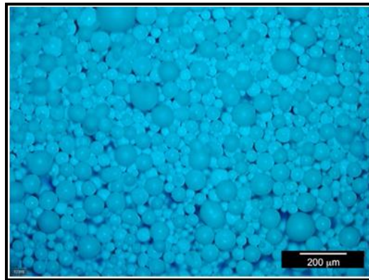
شكل (12.1): صورة بالمجهر الضوئي لمسحوق 3Y-TZP (Denry & Kelly 2008).
