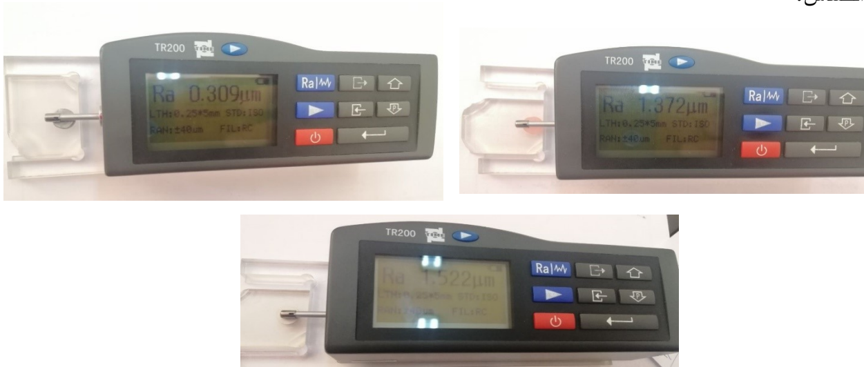
الشكل 2-31 : إختبار الخشونة للعينات من المجموعات الثلاث
