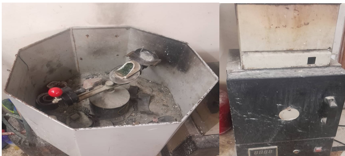
الشكل 2-18 : فرن حراري وجهاز طرد مركزي لصب المعدن.
