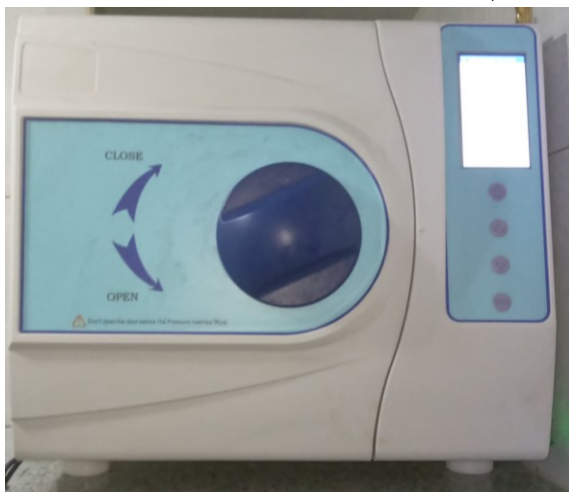
الشكل 2-32 : الصاد الموصد لتعقيم العينات
