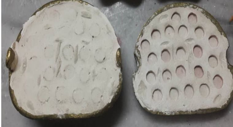
الشكل 2-23 : إذابة بقايا الشمع ثم عزل الجبس بالسلكات
