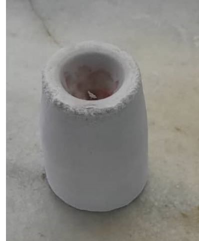
الشكل 2-28 : كسو العينات الشمعية بالمسحوق الكاسي
