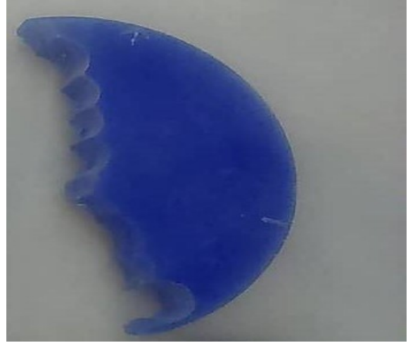
الشكل 2-27 : نحت العينات على أقراص شمعية باستخدام CAD/CAM
