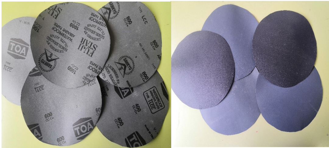
الشكل 2-5: ورق زجاج متدرج الخشونة ( 400-600-800-1000-1200 )
