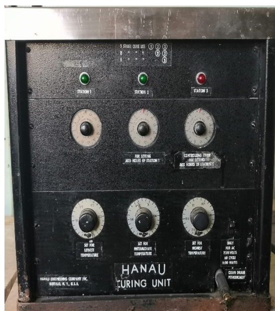
الشكل 2-14: جهاز تصليب الراتنج الأكريلي
