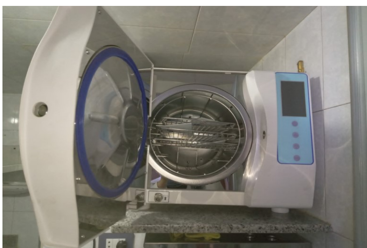
الشكل 2-17 : جهاز أوتوكلاف
