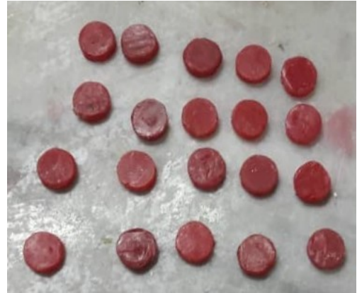
الشكل 2-22 : القطع الشمعية المنحوتة باستخدام CAD/CAM
