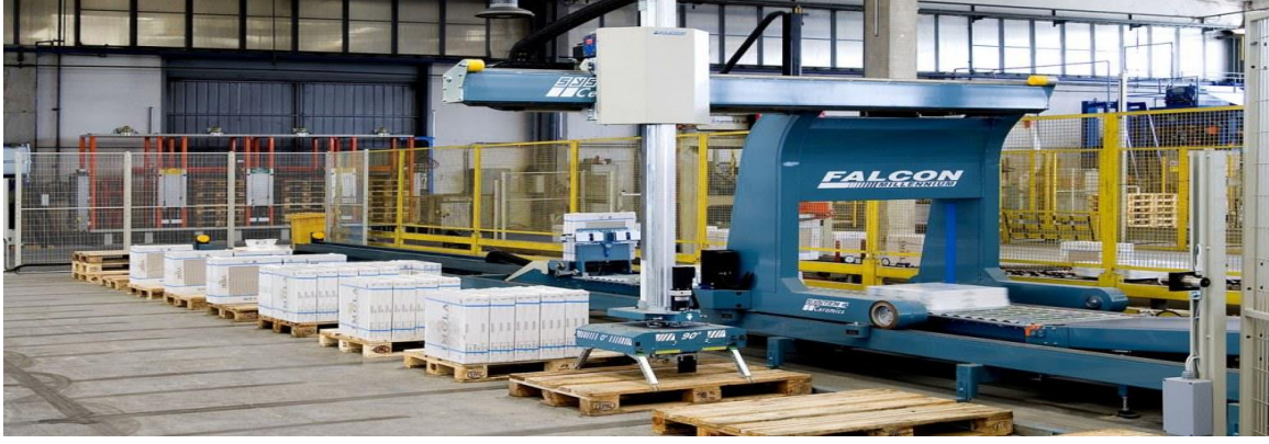
الشكل (1 - 30) الروبوت الذي يقوم بإنزال صناديق بلاط السيراميك على المنصات الخشبية
