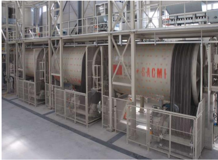
الشكل (1 - 6) شكل عام للمطاحن المستمرة
