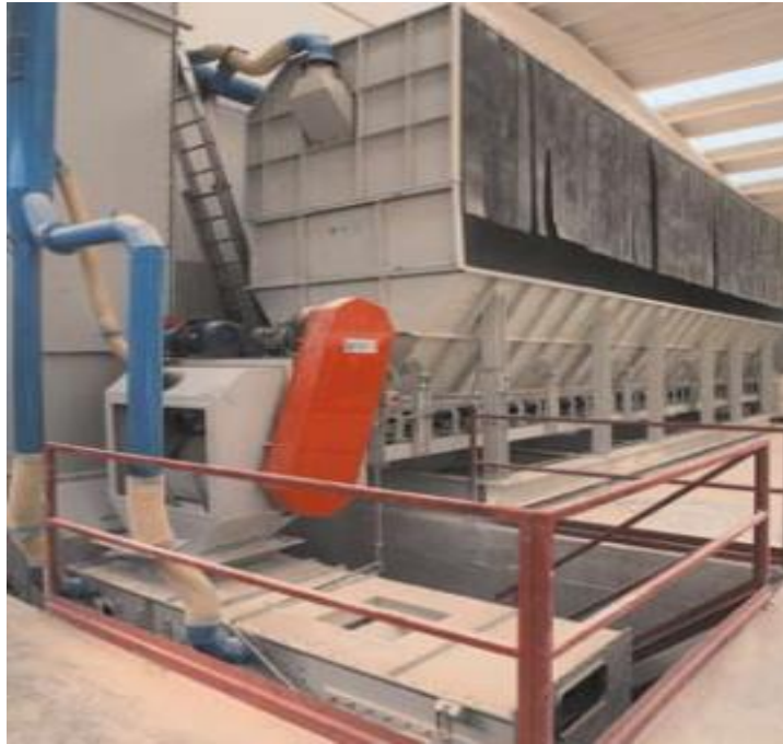
الشكل (1 - 4) الخزانات المعدنية التي تنقل إليها المواد الأولية
