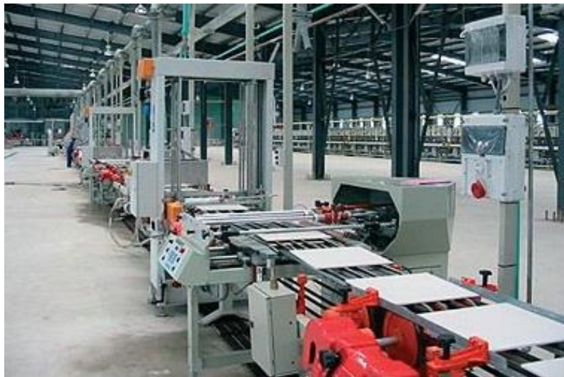
الشكل (1 - 18) أجزاء من خط الطلاء بالجليز
