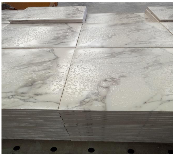
الشكل (2 - 11) الندبات الكبيرة على سطح الجليز (الغليان)
