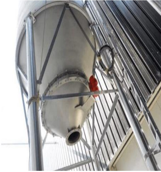
الشكل (3 - 7) جهاز الرجاج الواجب استخدامه على مخرج خزانات حفظ المواد
