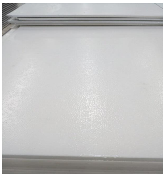
الشكل (2 - 12) الندبات الصغيرة على سطح الجليز (الغليان المصغر)
