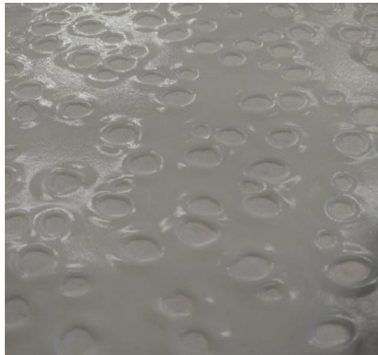
الشكل (2 - 11) الندبات الكبيرة على سطح الجليز (الغليان)
