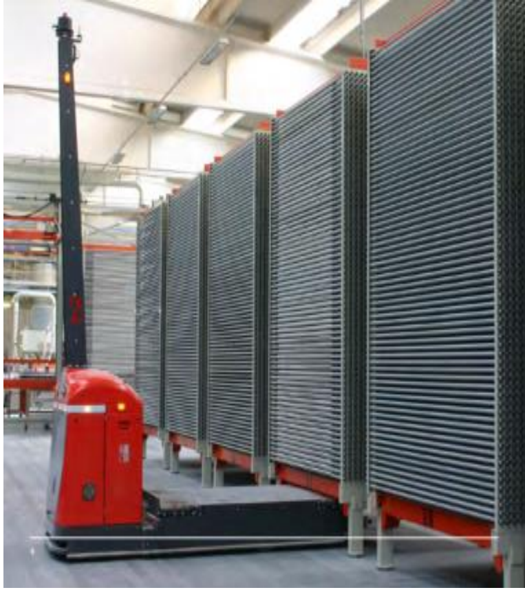
الشكل (1 - 22) عربات تخزين السيراميك قبل الشواء مع السيارة الحاملة لهذه العربة
