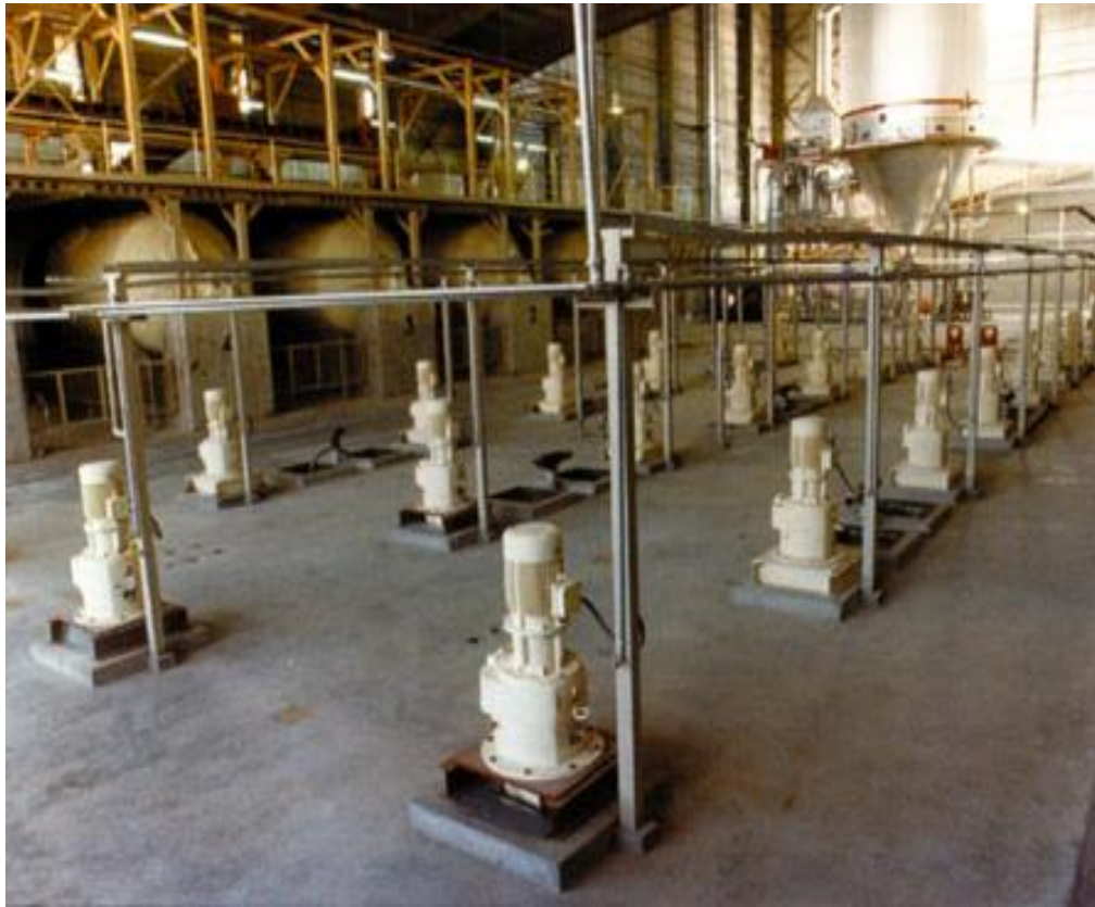
الشكل (1 - 8) الخلاطات المركبة للآبار الأرضية
