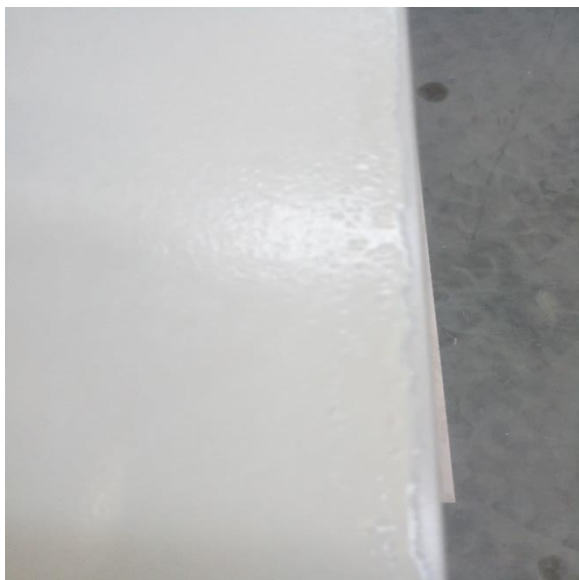
الشكل (2 - 12) الندبات الصغيرة على سطح الجليز (الغليان المصغر)
