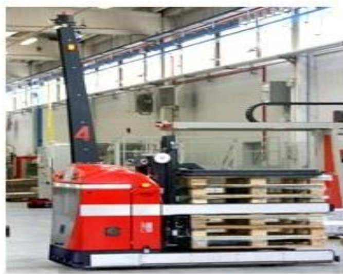
الشكل (1 - 31) السيارة التي تقوم بنقل المنصات الخشبية
