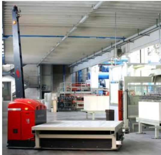
الشكل (1 - 27) منصات تخزين السيراميك المشوي مع السيارة الحاملة للمنصة
