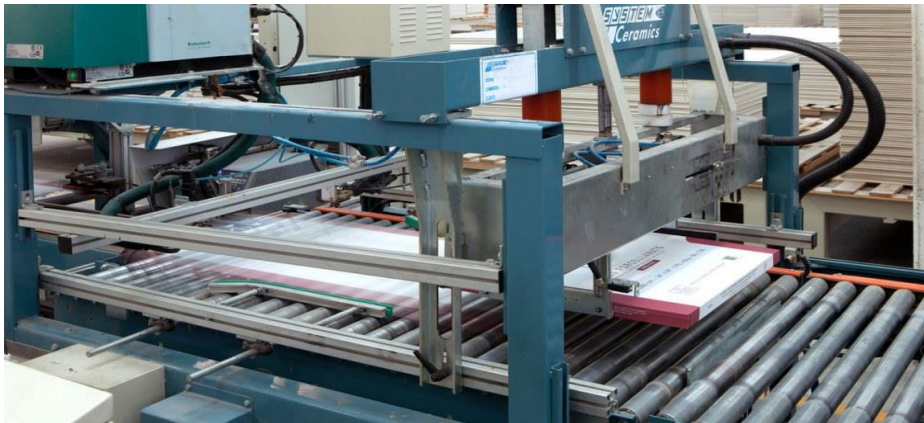
الشكل (1 - 29) الآلة التي تقوم بجمع الصناديق فوق بعضها البعض
