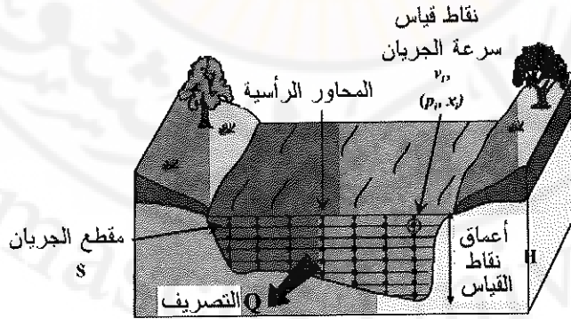
الشكل (32) المقطع العرضي للمجرى المائي وإحداثيات قياس السرعات
