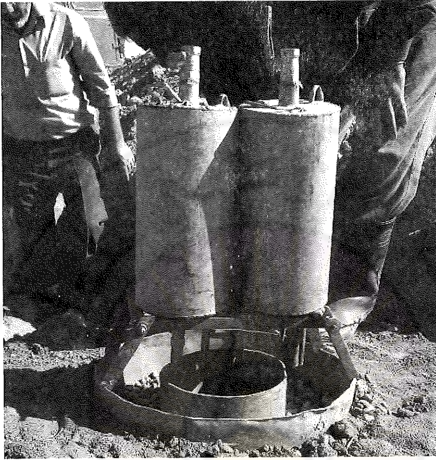
الشكل (28) وضعية جهاز نستروف أثناء تنفيذ التجربة
