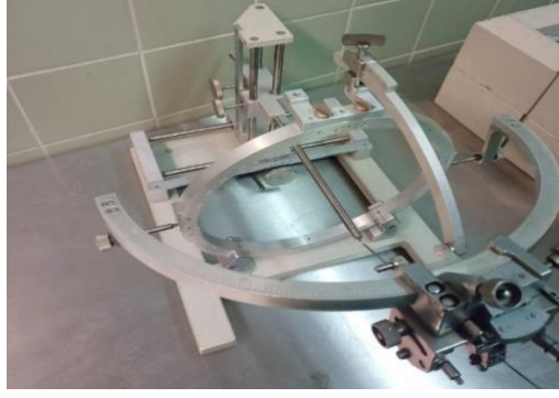
الشكل (1-4) يوضح جهاز التصوير المجسم الذي تم استخدامه لأخذ الخزعات الدماغية
