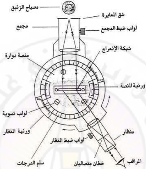
الشكل رقم (٣): مقطع عرضاني في المطياف وأجزائه
