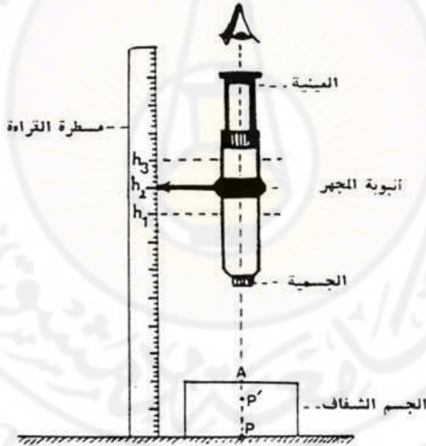
الشكل (٢): طريقة قياس الانسحابات الشاقولية بالمجهر المنزلق
