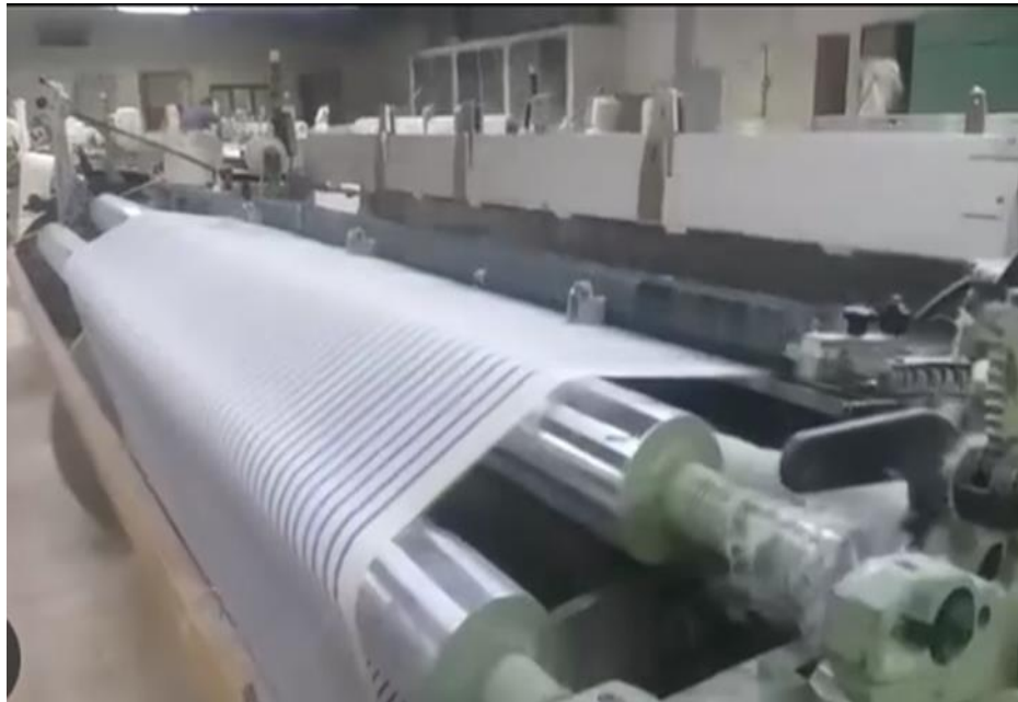
الشكل (3-3): نول سو لزر (PU 720).
