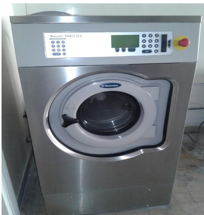
الشكل (3-6): الغسالة المستخدمة في اختبار الانكماش.
