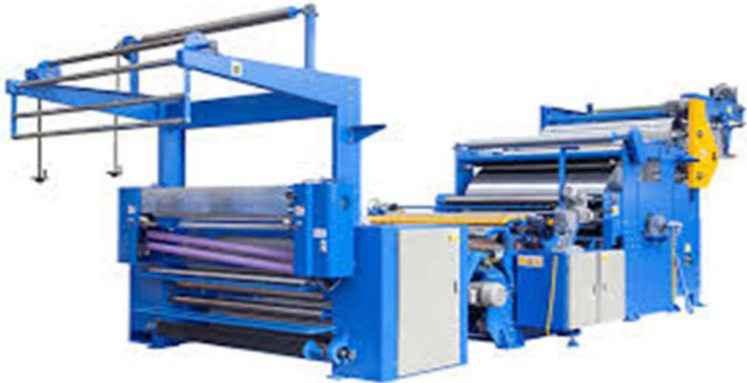
الشكل (1-6): آلة السنفرة (Sanforizing).
