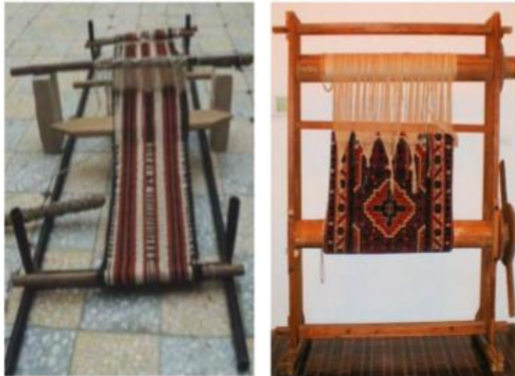
الشكل (38)، يوضح أشكال النول العمودي والأفقي
