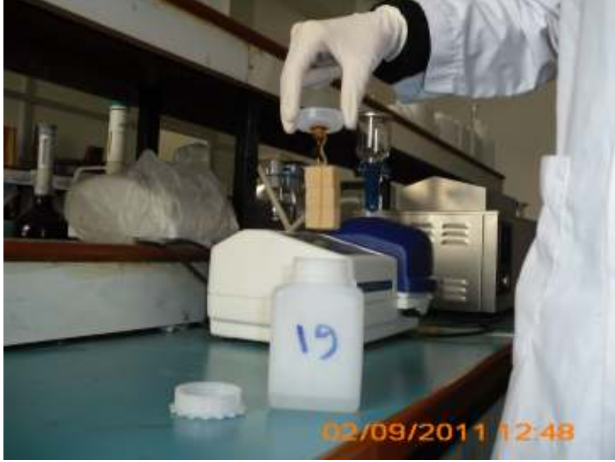
شكل رقم (20): إيلاج العينة داخل القارورة.
