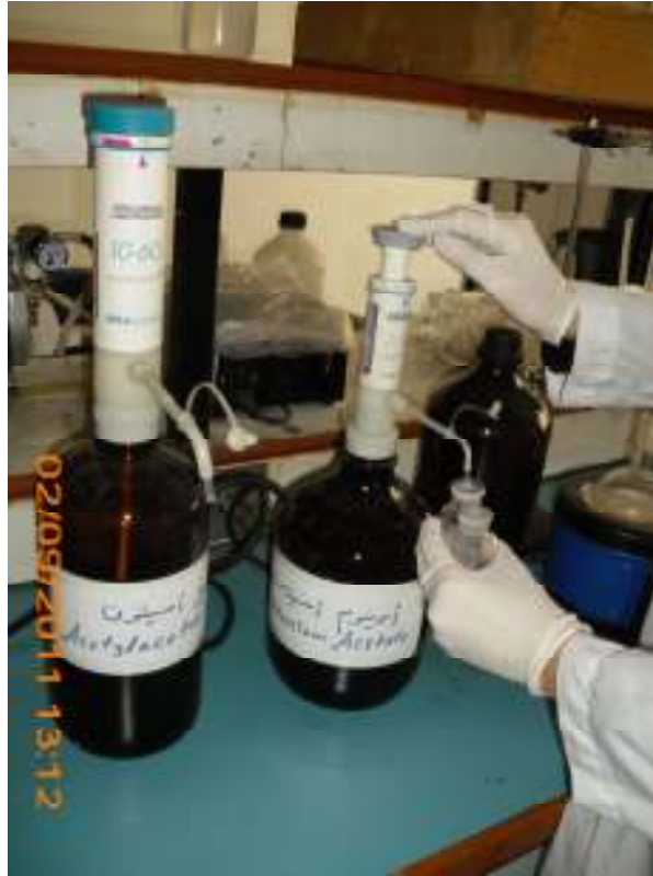
شكل رقم (24): إضافة الأمونيوم أستيات والأستيل أسيتون إلى الزجاجات باستخدام الديسبانسر.
