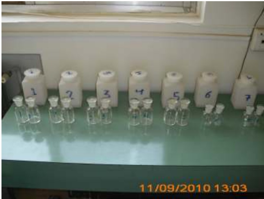
شكل رقم (22): ترتيب الزجاجات سعة 50 مل بمعدل زجاجتين لكل قارورة WKI.
