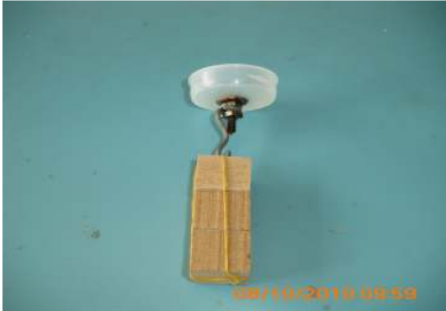
شكل رقم (19): تعليق العينة الخشبية بخطاف غطاء القارورة.
