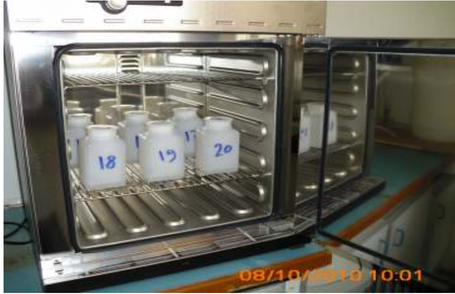
شكل رقم (21): وضع القوارير داخل المجففة الهوائية.
