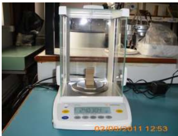
شكل رقم (18): وزن العينة المراد تقدير الفورم ألدهيد منها.
