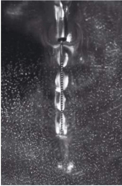
شكل (5) - الدوامة الصوتية المجهرية Acoustic streaming (van der Sluis LWM, 2007)
