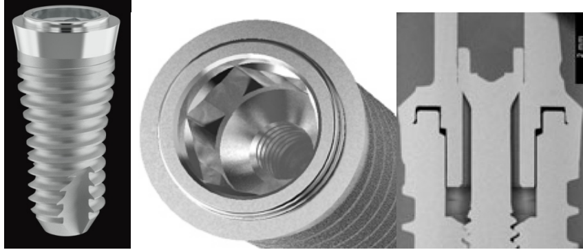
الشكل 12: يبين زرعة SPI Contact الشكل العام ومنطقة الاتصال الداخلي السداسي والنتوء المقاوم للحركات الجانبية.
