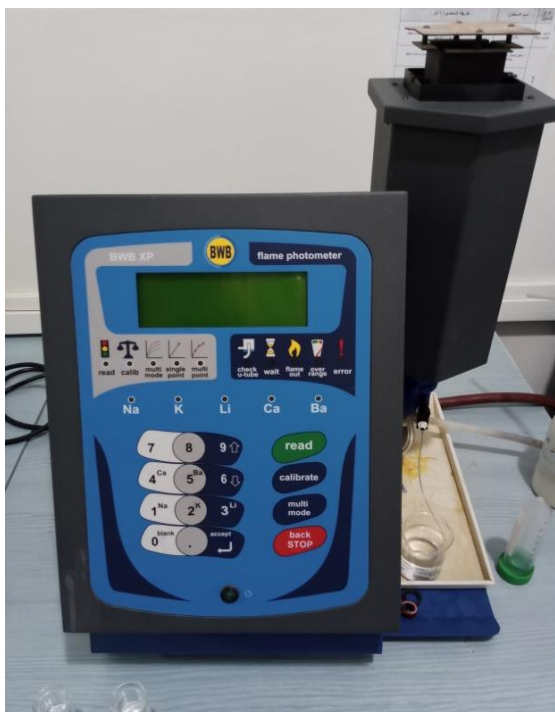
الشكل (36): جهاز مطياف اللهب المستخدم لتقدير العناصر المعدنية.
