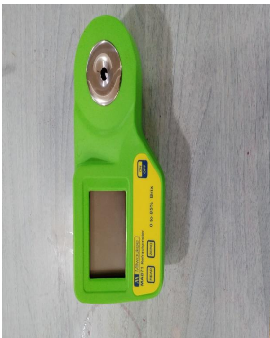
الشكل (38): جهاز رفاكتو ميتر رقمي المستخدم لقياس الـ TSS.
