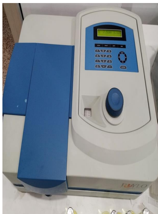
الشكل (37): جهاز المطياف الضوئي المستخدم في تقدير الفوسفور.
